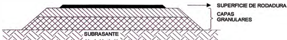
Figura 2.1: Capas requeridas para estructuras de pavimentos
