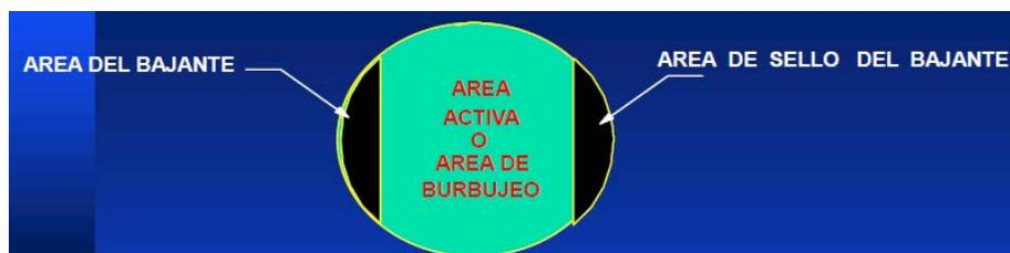
**FIGURA N° 9: PARTES DE UN PLATO DE UN PASO - VISTA ELEVACIÓN**
