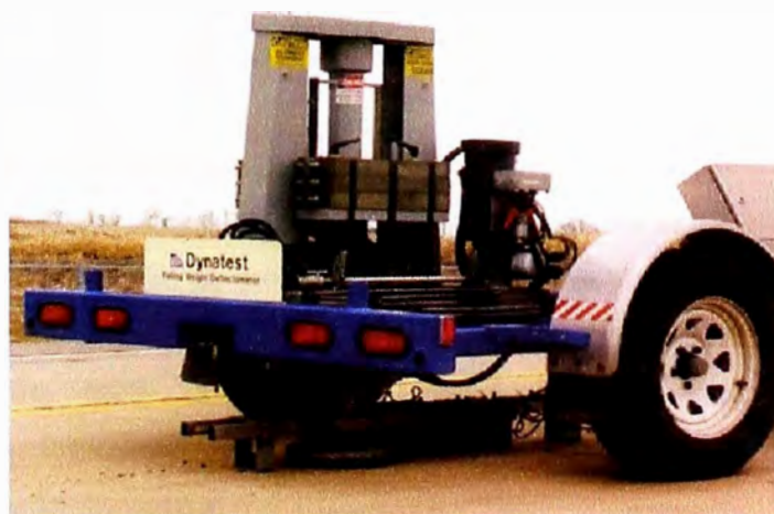
Figura N° 3.03 Deflectómetro Falling-Weight (FWD)
