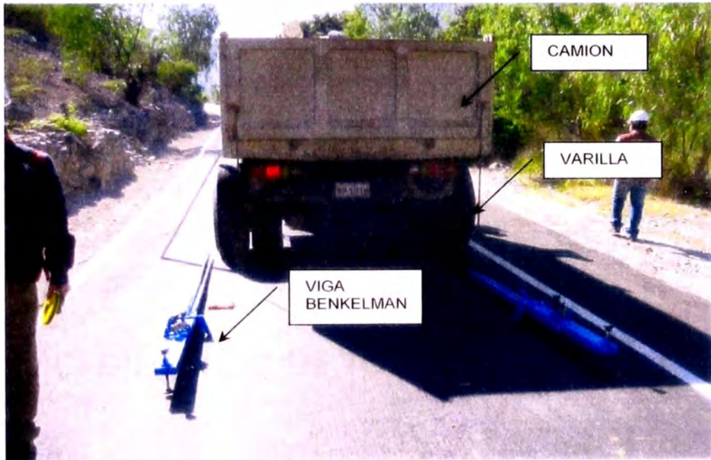
FIGURA: VARILLAS, CAMION Y VIGA BENKELMAN
