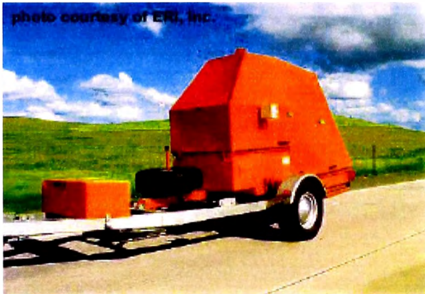
FIGURA N° 2.7 EQUIPO KUAB - FWD
