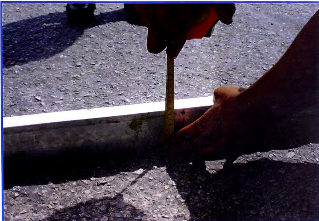
Foto 8: Medición del ahuellamiento en el punto de toma de datos, con una regla de aluminio de 3 m de longitud y wincha.
