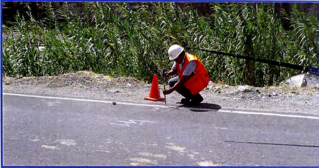
Foto 5: Extracción de la muestra de superficie de rodadura para la determinación del espesor de la vía.
