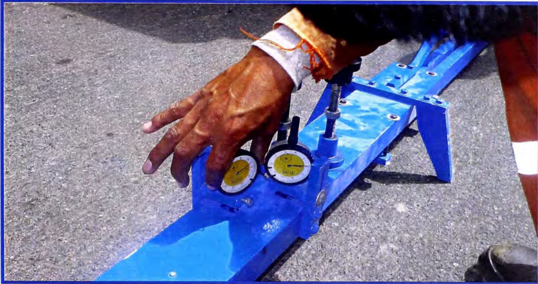
Foto 3: Calibración del equipo Deflectómetro Viga Benkelman para realizar las mediciones.
