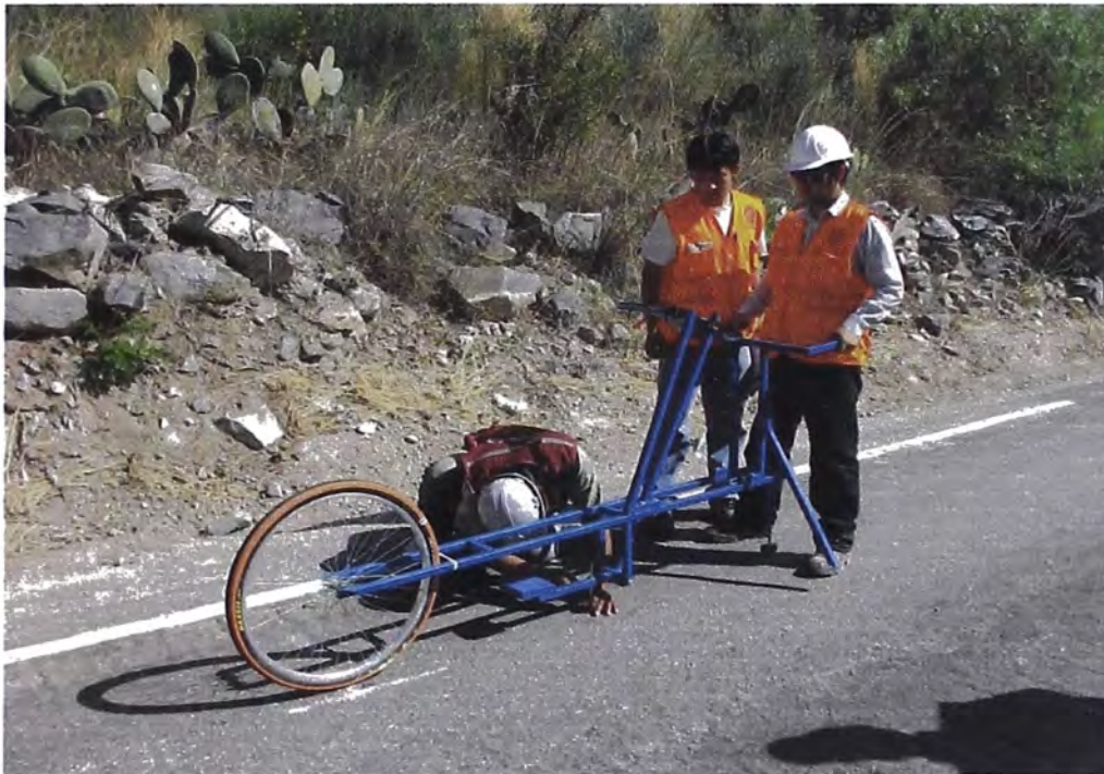
Fotografía mostrando el proceso calibración del equipo Merlin
