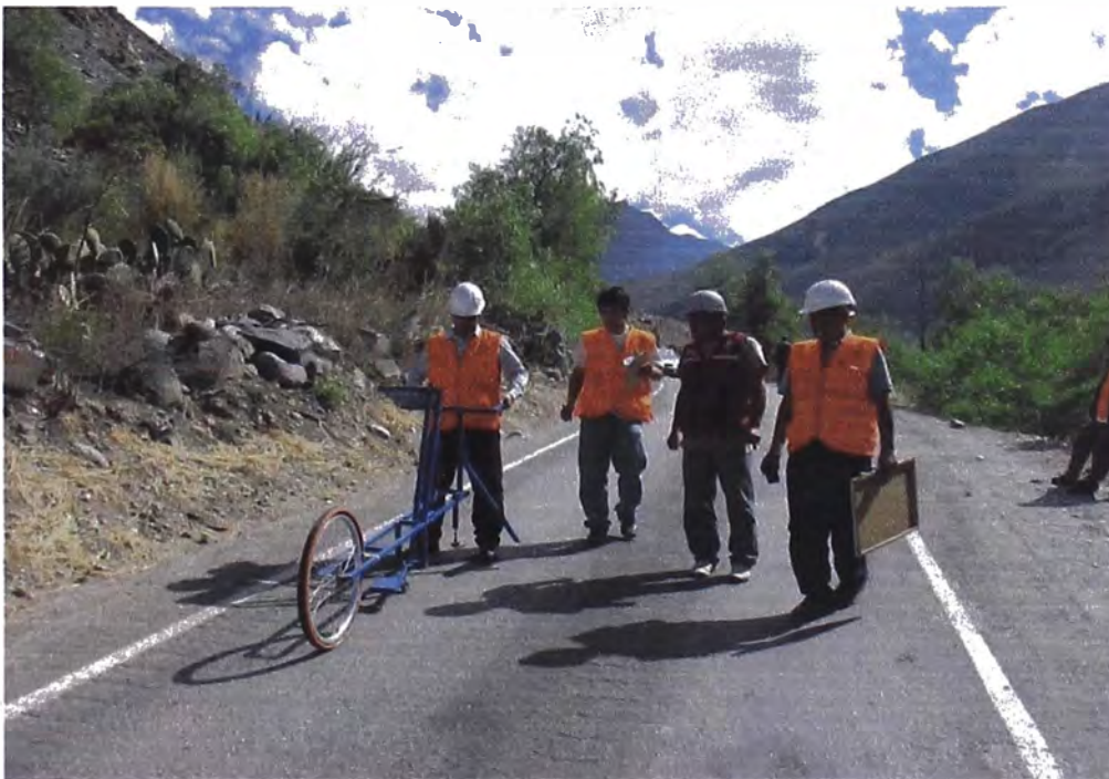
Fotografía mostrando el proceso de medición del IRI
