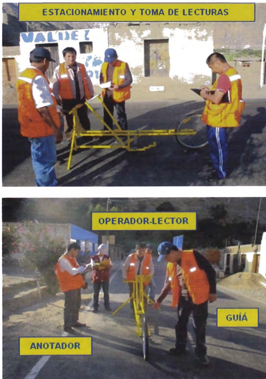
Figura 4.04: Procedimiento de trabajo con el equipo MERLIN
