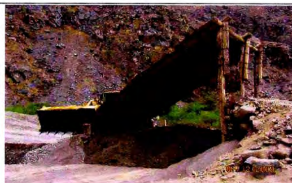
Fotografía N° 1.10: Producción de gravilla de 3/8" para monocapa.
