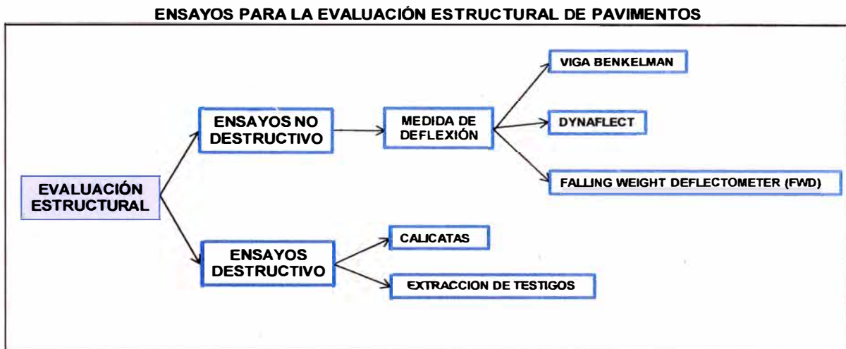
Figura N° 2.01: Ensayos para la evaluación estructural de pavimentos
