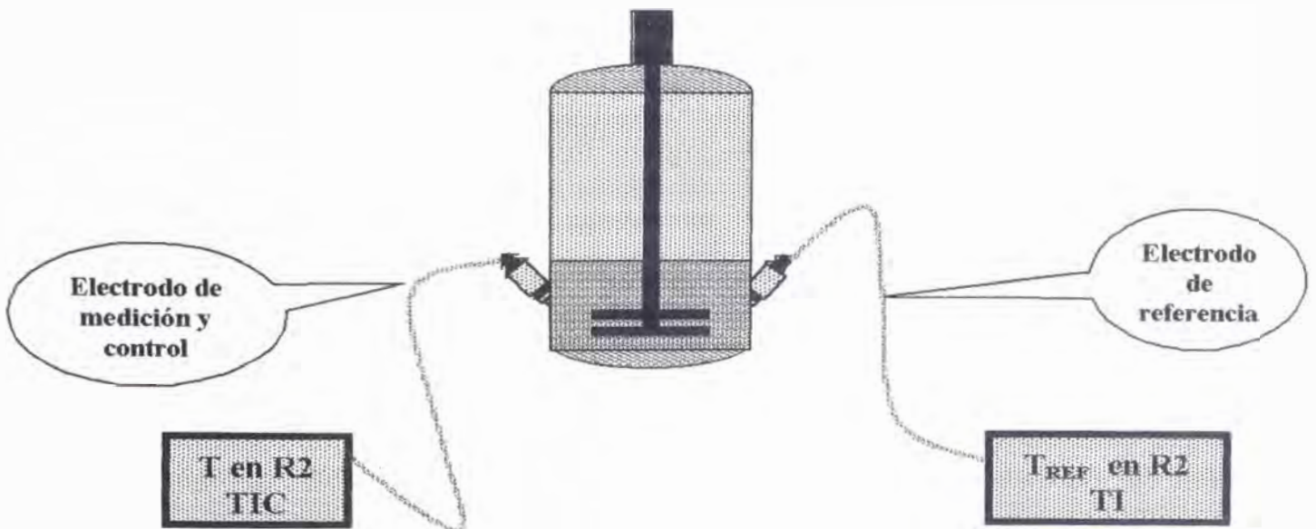
Figura 19 Posición de los 2 electrodos de pH (principal de medición y control y referencial) en R2
