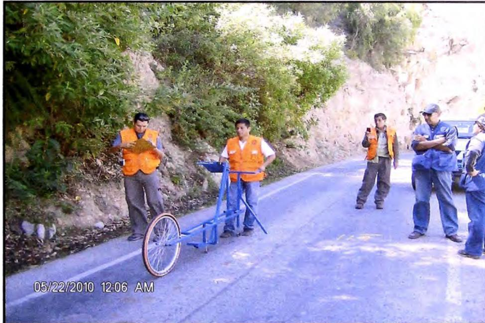
**FOTO A3.3.** Evaluación de campo del IRI con equipo Merlin. Carril izquierdo. Secciones de calibración.
