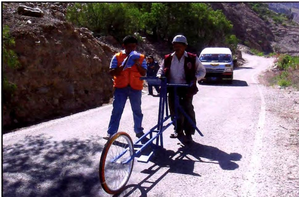
**FOTO A3.4.** Evaluación de campo del IRI con equipo Merlin. Carril Derecho. Secciones de calibración.
