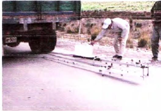
**FIGURA N° 2.02. ENSAYO CON LA VIGA BENKELMAN**
