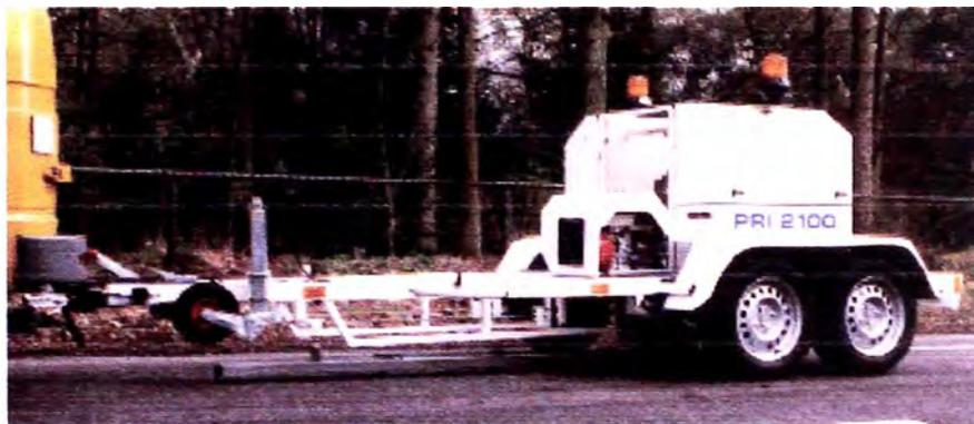
**FIGURAN° 2.03. ENSAYO CON EL DEFLECTOMETRO DE IMPACTO**
