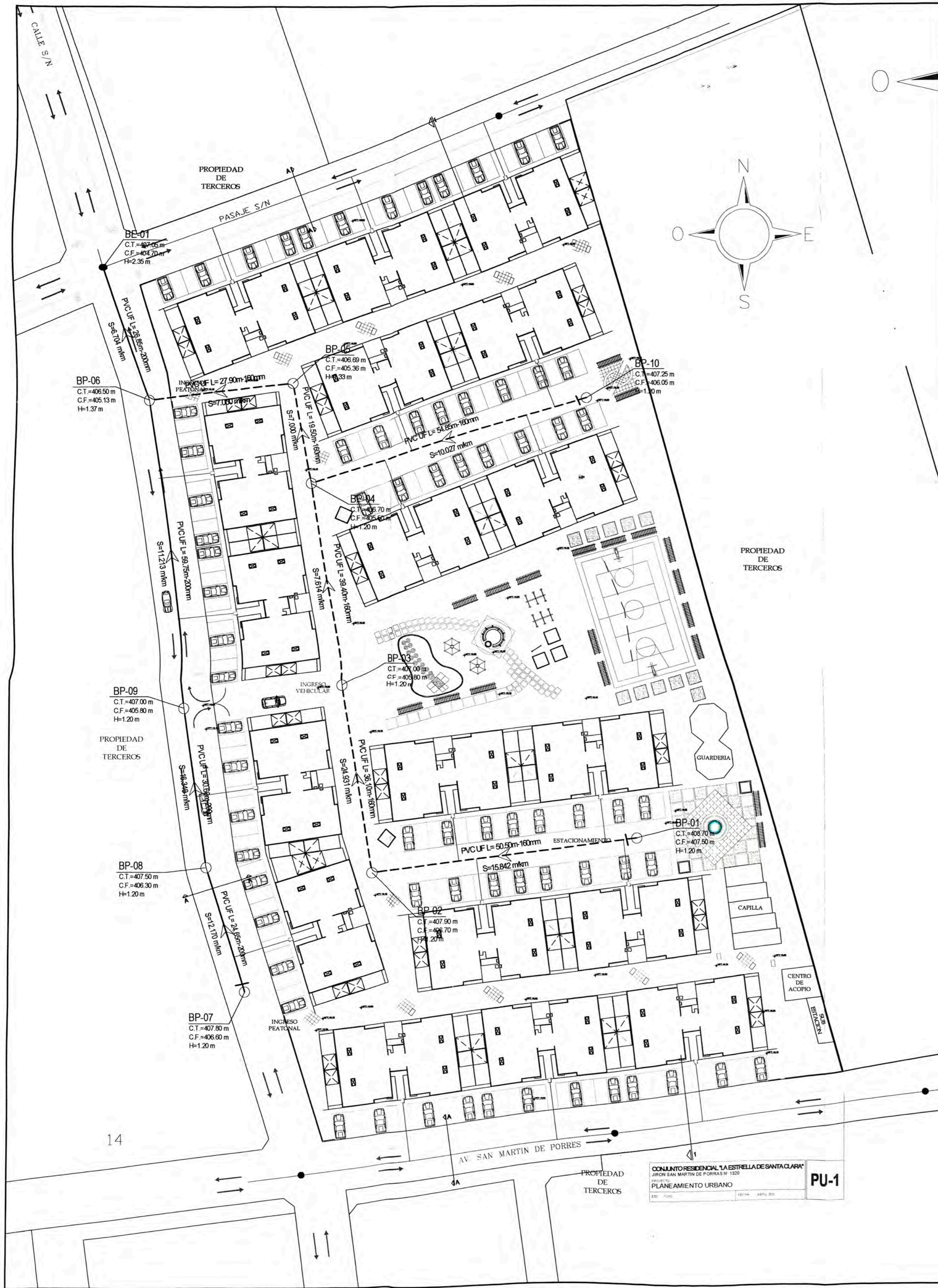
PLANTA REDES DE ALcantarillado 1/500
