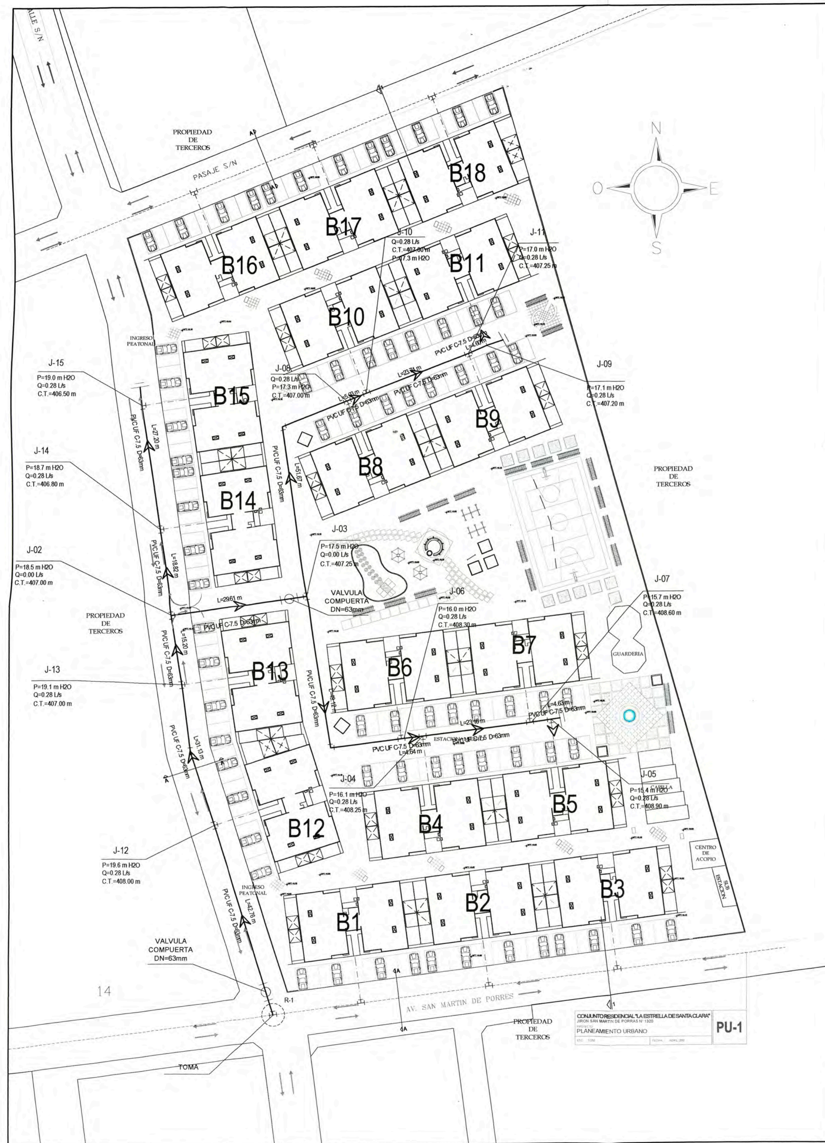
PLANTA REDES DE AGUA POTABLE 1/500
