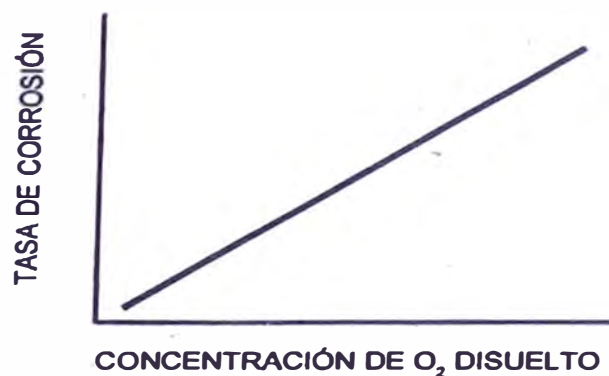
Gráfico 18: Oxígeno aumenta tasa de corrosión
