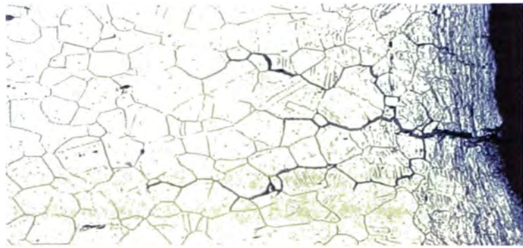
Gráfico 15: Corrosión por tensión - Intergranular
