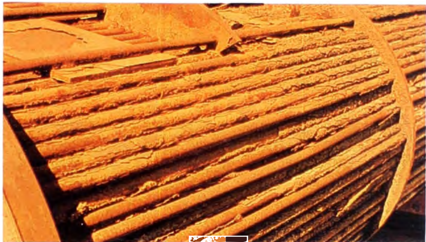
Gráfico 24: Problema crítico de incrustación en un Intercambiador
