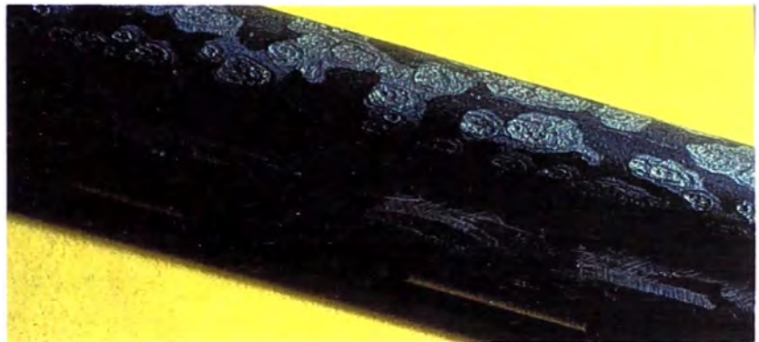
Gráfico17: Corrosión por influencia microbiológica
