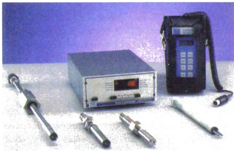
Gráfico 38: Equipo para medición de la tasa de corrosión
