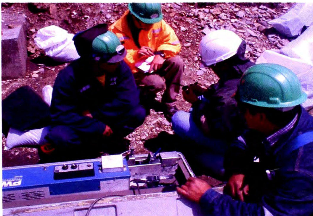
Fotografía N° 11 : Realizando los ensayos de pelado y desgarre en el Tensiómetro.
