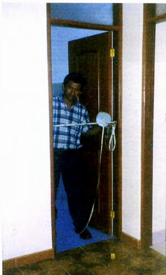
**Foto 3** Levantamiento Arquitectónico con el fin de obtener el actual plano de distribución arquitectónica (Plano A-03).
