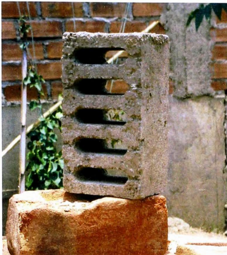
*Foto 7.- Ladrillo king concreto, usado en el 90% de los nuevos muros de la edificación ampliada y remodelada.*
