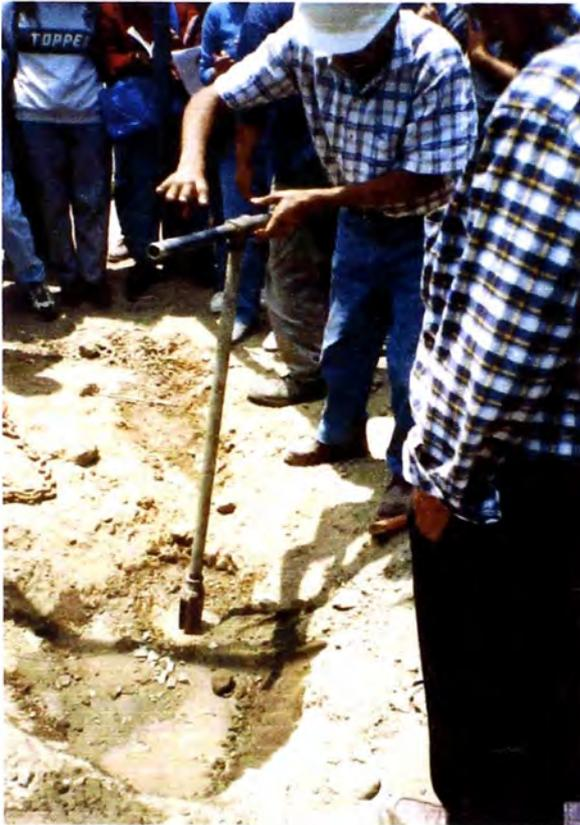
En este sistema de perforación se conecta una pequeña bomba de agua que inyecta un chorro continuo de agua a las varillas de extensión que son huecas y acaba en taladro, puntero o cincel con orificios laterales por donde el agua sale a presión. Conforme se va percutando o rotando contra el fondo de la perforación el agua a presión va lavando y expulsando las partículas de suelo.
