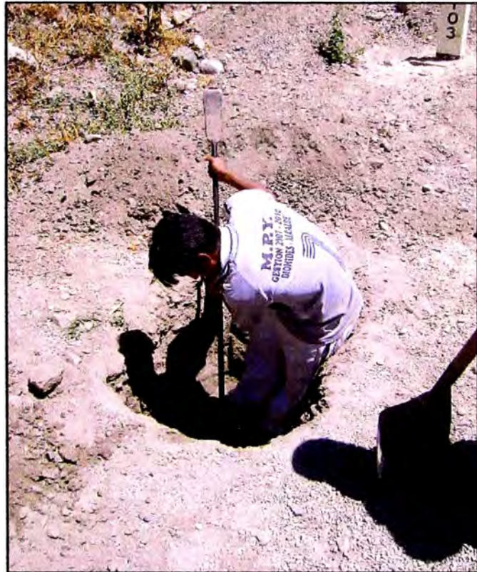
KM 103+000 – CALICATA DE EXPLORACIÓN
