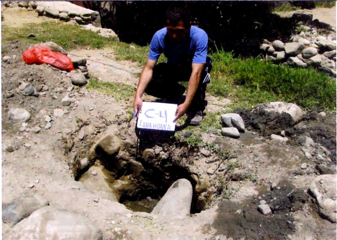
Foto N° 5: Se observa la Calicata C-4, de profundidad 1.50m, para la línea de Aducción; presenta material orgánico con conglomerados de tamaño de 10"-15", también se observó presencia de nivel freático a unos 0.80m de profundidad.
