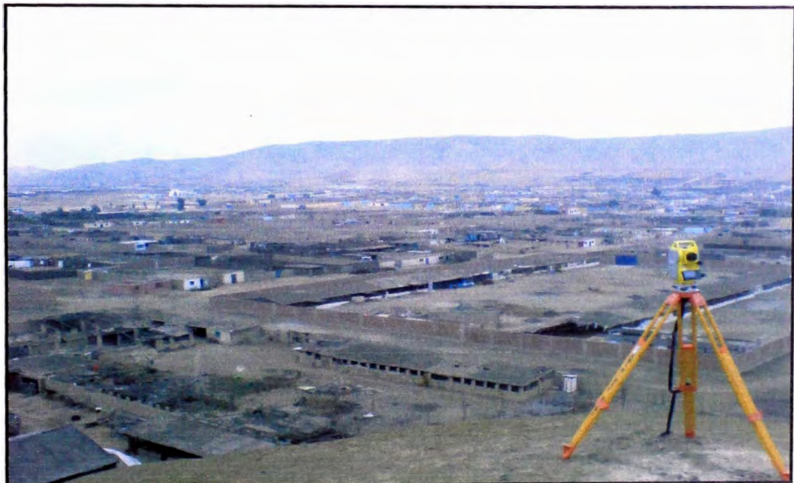
LEVANTAMIENTO TOPOGRÁFICO CON TEODOLITO ELECTRÓNICO (VISTA PANORÁMICA)
