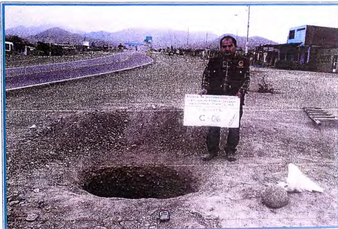
Foto N ° 12: Vista panorámica de la ubicación de la calicata C6, observándose los suelos granulares encontrados.
