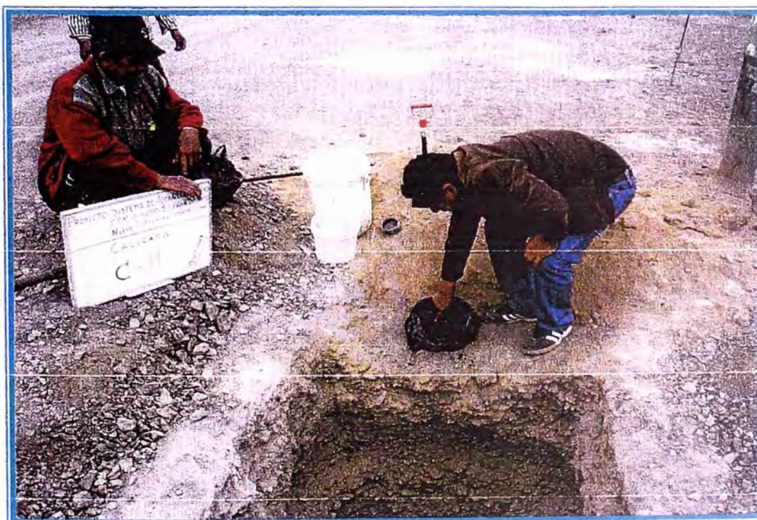
Foto N ° 26: Vista panorámica de la ubicación de la calicata C11, observándose la toma de densidad natural por el método de reemplazo de agua.
