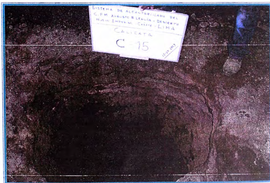
Foto N ° 34: Vista del interior de la calicata C15, observándose los suelos granulares encontrados con cementaciones
