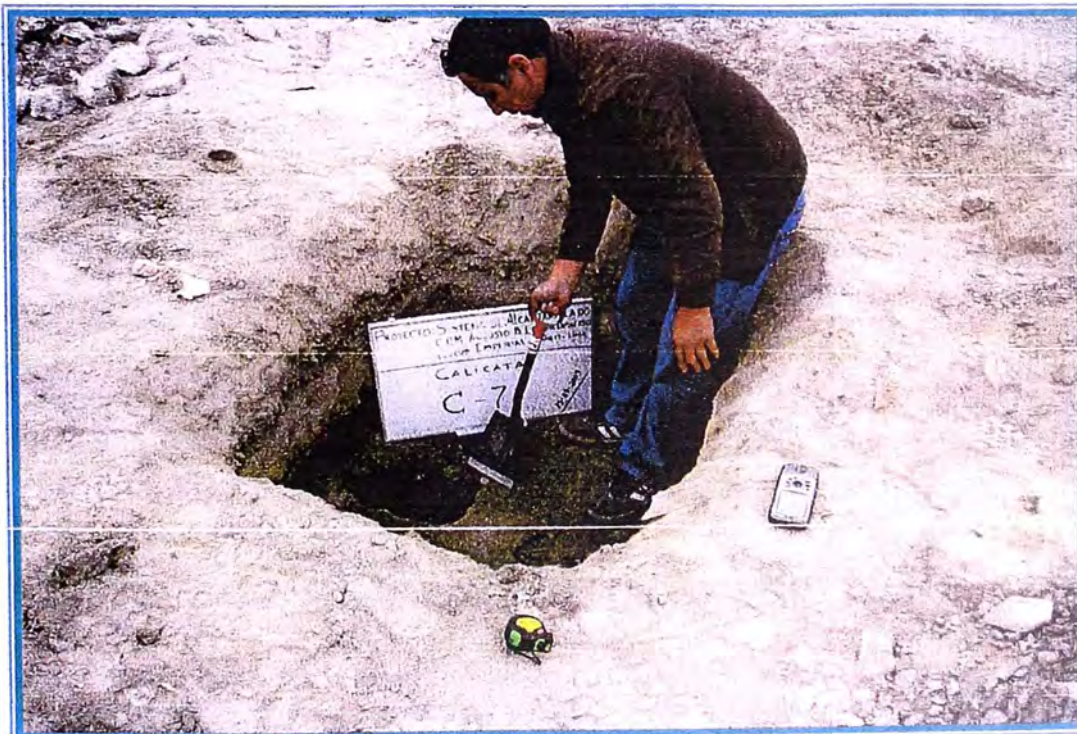
Foto N ° 16: Vista del interior de la calicata C7, observándose los suelos granulares encontrados y las cementaciones (caliches) de difícil excavación manual.
