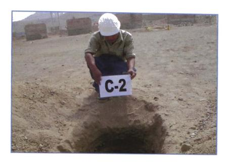
Foto Nº 2.03. Excavación de la calicata C-2.
