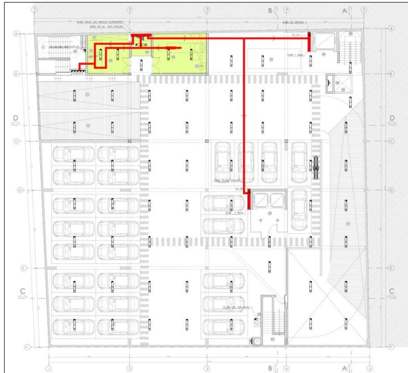
FIGURA 18. Primer sótano. Esquema de distribución de las instalaciones eléctricas. Ubicación de subestación eléctrica, grupo electrógeno, paneles de instalaciones eléctricas y circuito de redes eléctricas y de telecomunicaciones. Elaboración propia
