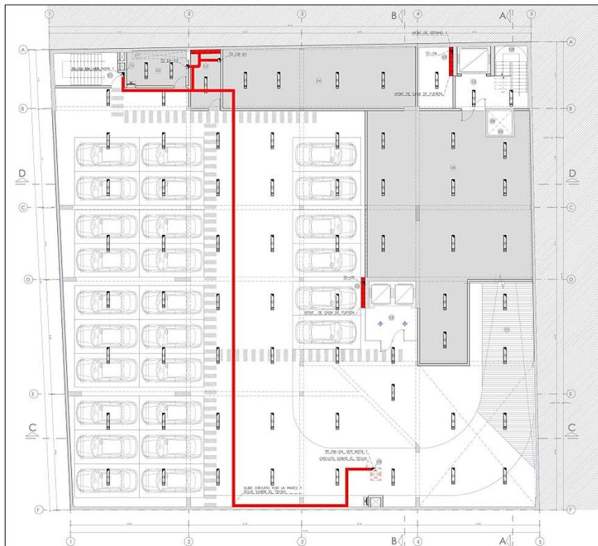
FIGURA 17. Segundo sótano. Esquema de distribución de las instalaciones eléctricas. Ubicación de paneles de instalaciones eléctricas y circuito de redes eléctricas y de telecomunicaciones. Elaboración propia
