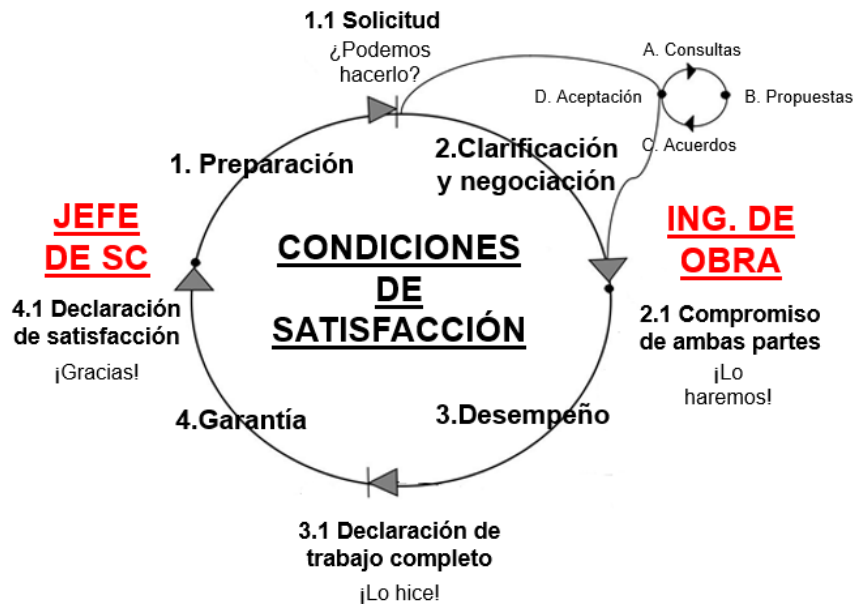
Figura N°3.13 Flujo de compromisos para la validación del diseño del producto Fuente: Adaptado de Howell G., Macomber H., Koskela L. & Draper J. (2004) & Mossman A. (2017)
