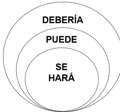
Figura N°2.14 Sistema de planificación lean Fuente: Adaptado de Ballard G. & Hamzeh F. (2007)
