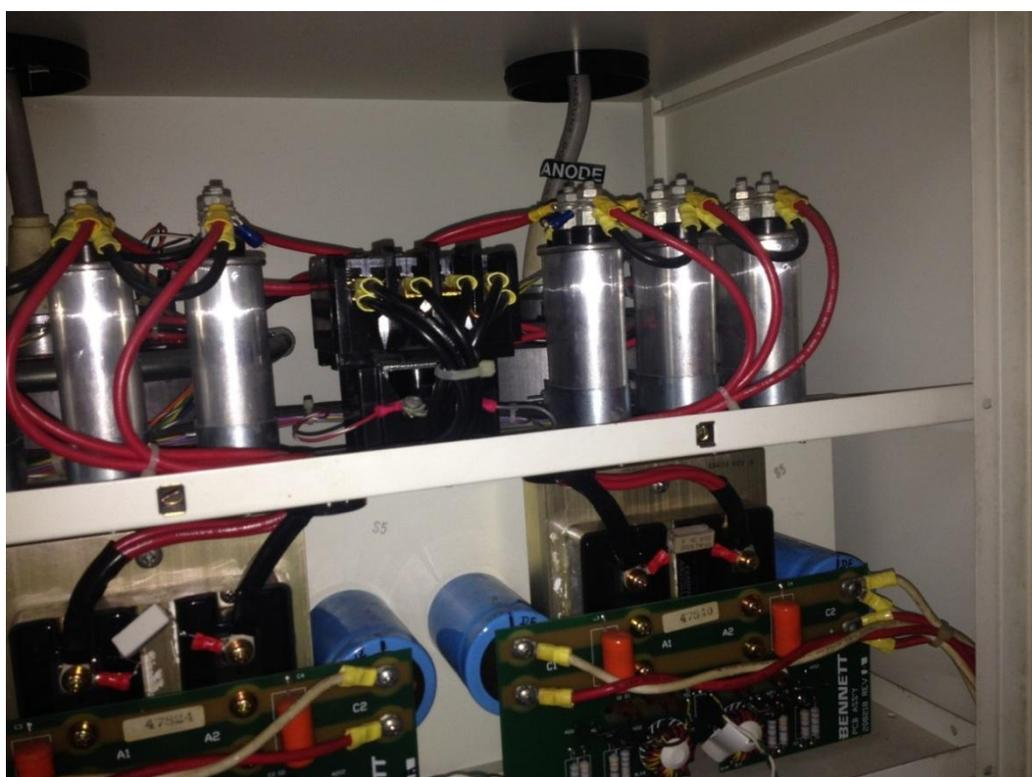
BANCO DE CONDENSADORES DE LA FUENTE DE ALIMENTACIÓN DEL EQUIPO DE RAYOS X MARCA BENNET
