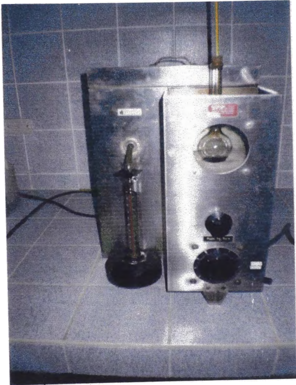
Fotografía N°1. Destilador ASTM D-86
