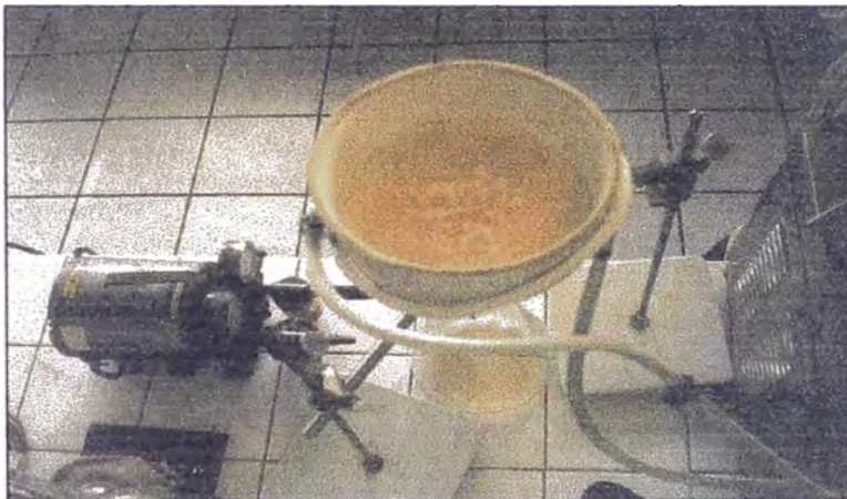
Fotografía N°10. Filtración del aceite
