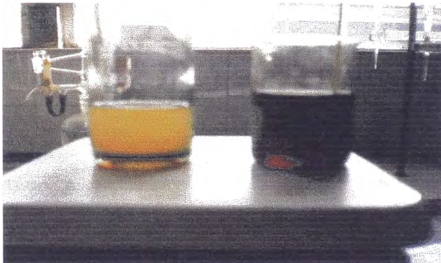
Fotografía N°8. Aceite antes (derecha) y después (izquierda) del desaromatizado
