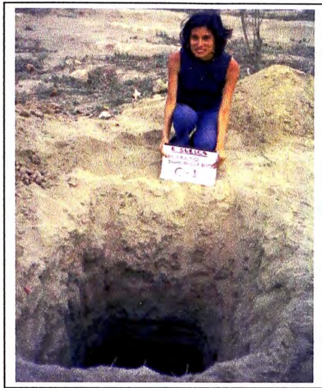
FOTO N° 1: Calicata N° 01, nótese la vegetación superficial alrededor de la calicata, así como el material superficial arcilloso de color marrón claro.
