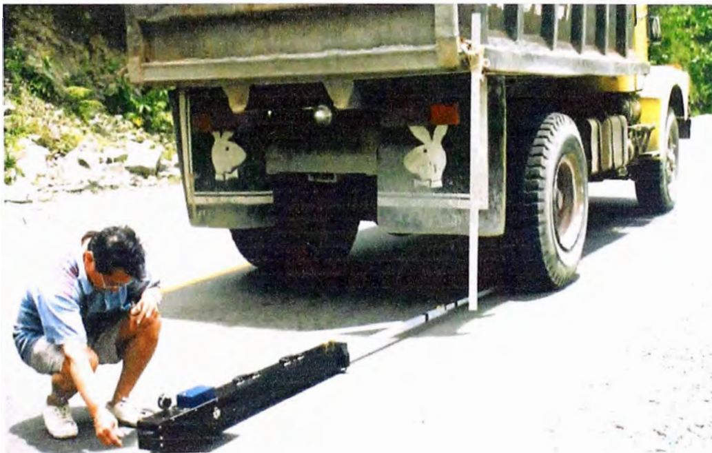
Fotografía 2.3-2 Aplicación de la viga beckelman
