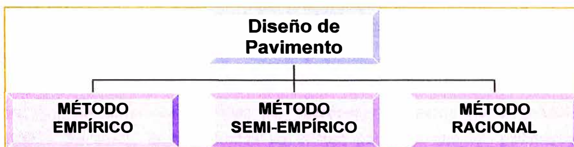
Ilustración 2.3-1 Clasificación de los Métodos de Diseño de Pavimento
