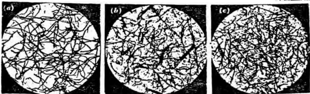
Fig. 3.15. Fotomicrografías de pulpas. (a) Pasta mecánica buena (de maderas suaves), para papel para periódico. Aumento 7X. Las fibras están bien separadas y tienen bastante área superficial como resultado de la fibrilación. (b) Pasta mecánica mala (de maderas suaves), para papel para periódico. Aumento 7X. Las fibras están pobremente separadas, como lo indica la presencia de muchos haces de fibras. Existen relativamente pocas fibras largas. La superficie se ha desarrollado por "corte" más que por fibrilación. (c) Pulpa al sulfito (de maderas suaves) para papel para periódico. Aumento 7X
