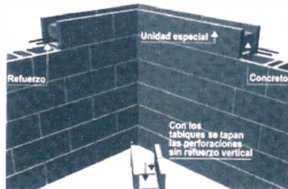
Figura 47. Construcción de las vigas de amarre
