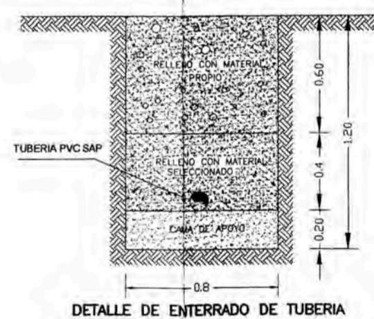
DETALLE DE ENTERRADO DE TUBERIA
