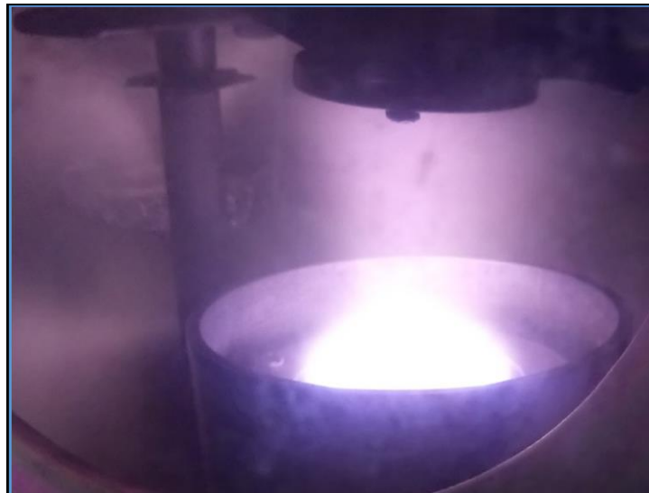
Figura 1.7 Vista de la descarga luminosa (plasma) en una cámara de sputtering.
