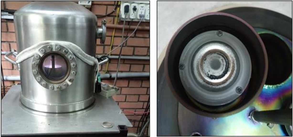
Figura 3.1 Vista exterior de la cámara de vacío, mostrada a la derecha, a la izquierda: un blanco de titanio dispuesto en el magnetron sputtering (diseñado y construido en el Laboratorio).
