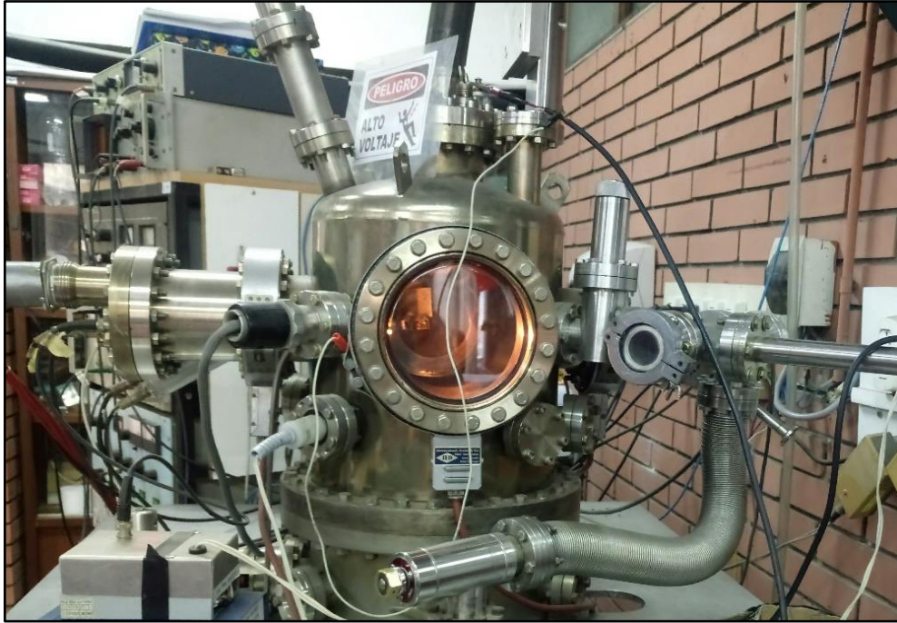
Figura 2.10 Equipo usado para la detección de electrones Auger. Laboratorio de Sputtering de la Facultad de Ciencias de la UNI.
