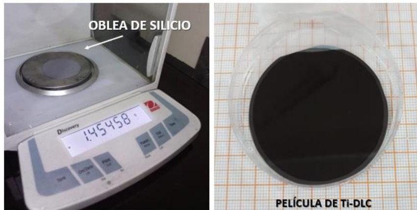
Figura 3.3 Imagen derecha: oblea de silicio usado como sustrato, en la imagen izquierda: una película de Titanio-DLC.
