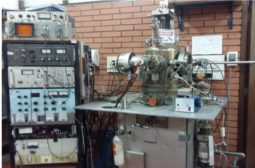
Figura 4.11. Equipo de Espectroscopía Electrónica Auger de Laboratorio de Sputtering, de la UNI.
