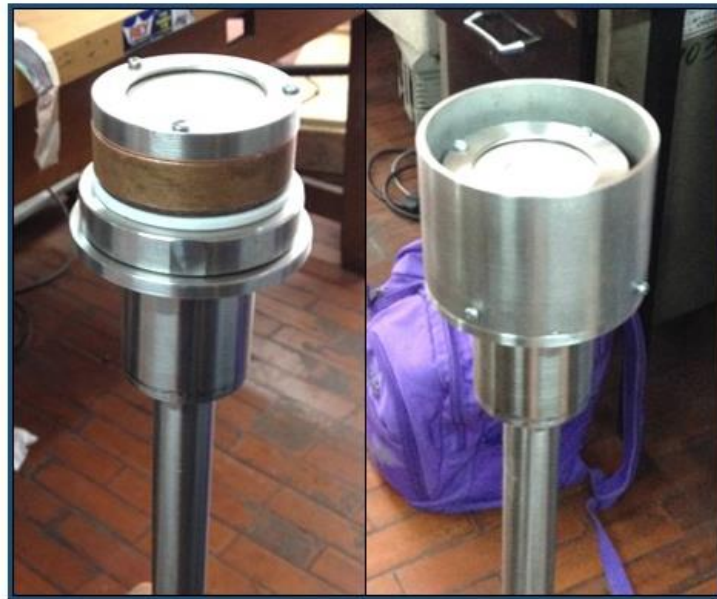
Figura 5.5. Construcción del magnetrón para un blanco de 2" de diámetro.
