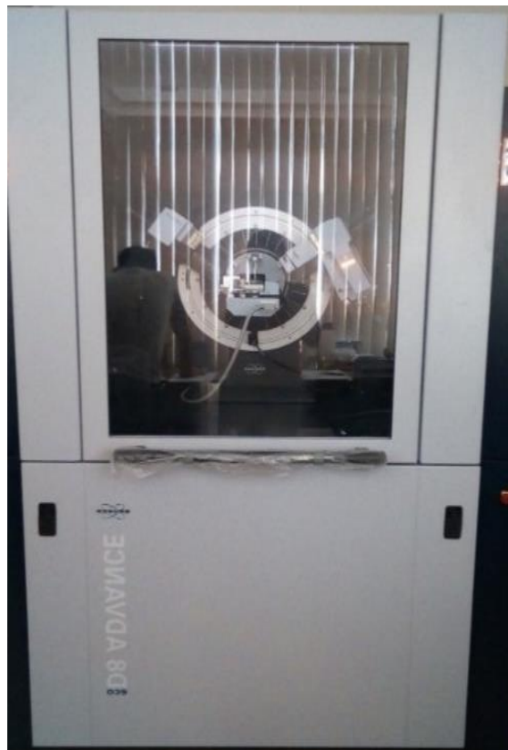
Figura 4.7 (a) Modo de análisis \theta : 2\theta . Configuración Bragg-Brentano. (b) Equipo de Difracción de Rayos X, de la UNI.
