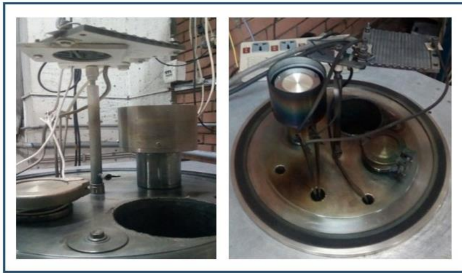
Figura 5.6. Instalación del magnetron en la cámara de vacío.
