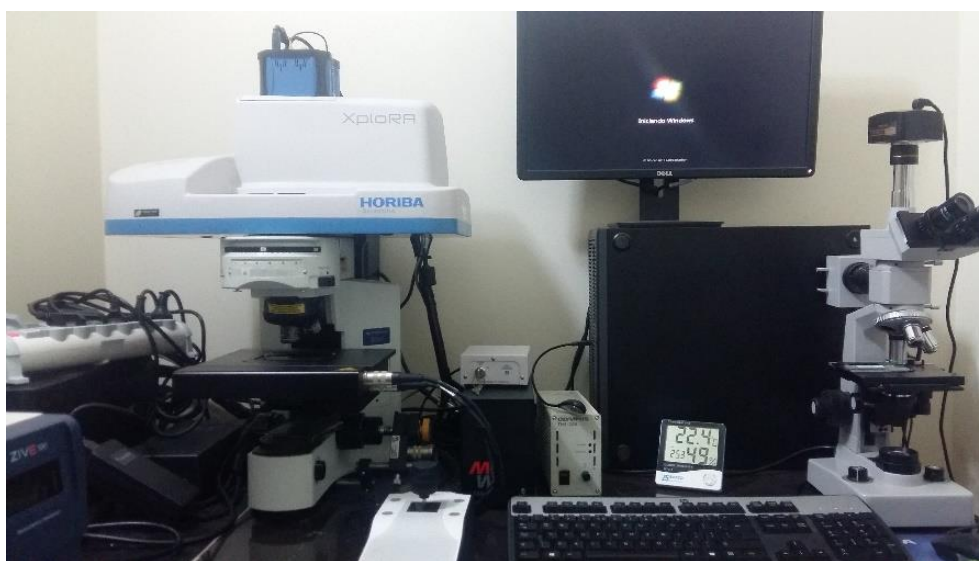
Figura 4.9. Equipo de Espectroscopía Raman del laboratorio de Química, de la UNI.
