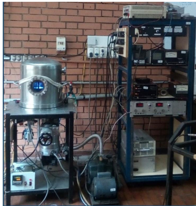
Figura 2.6. Cámara de vacío en el laboratorio de Sputtering presente la Facultad de Ciencias.
