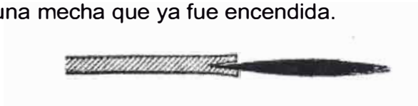
Fig. 2.3.- Mecha de seguridad mostrando el flamazo inicial que es un chorro de fuego que lanza la mecha al encenderse el núcleo de pólvora.
