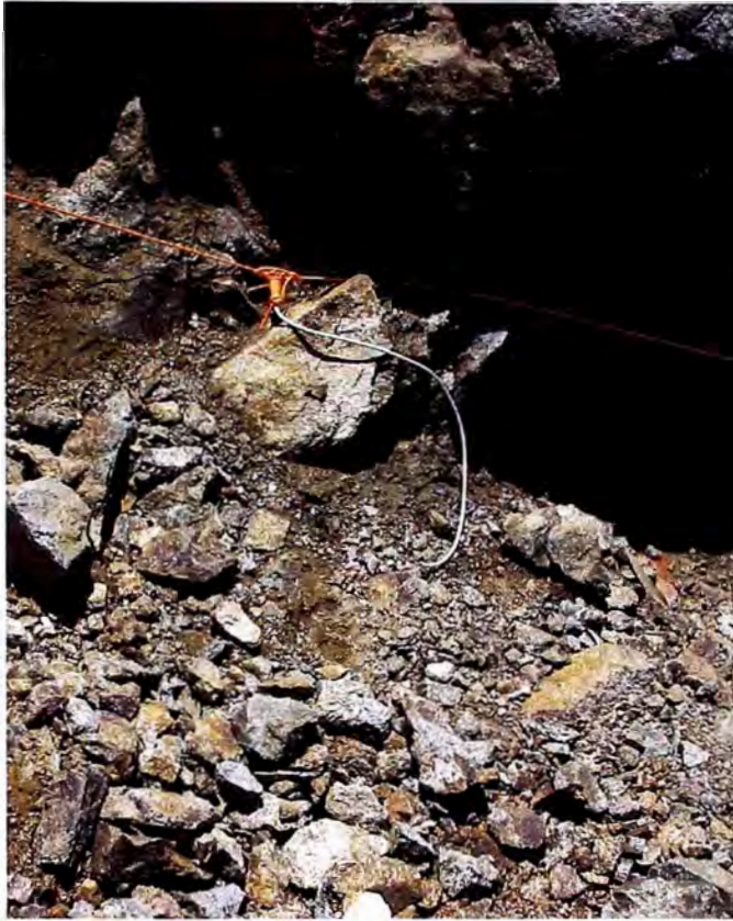
Foto N° 17.- Iniciador de la malla con mecha lenta
