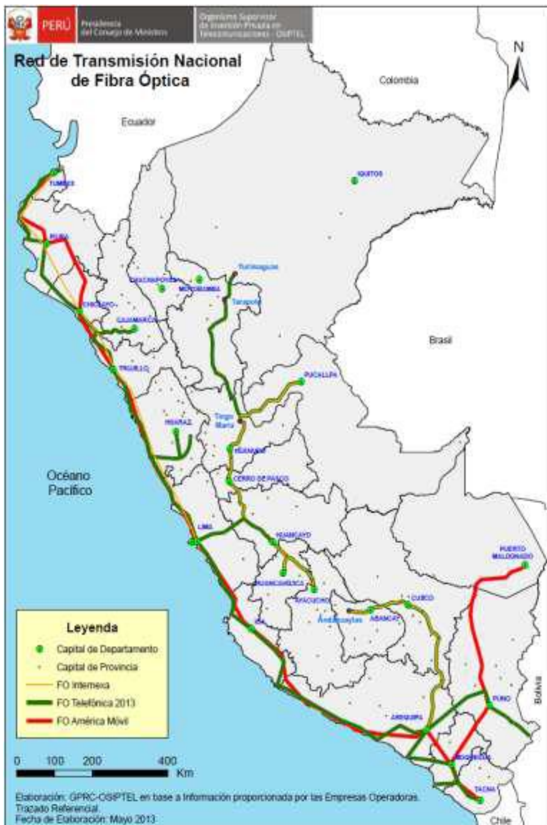
Fig. 1.1 Red de fibra óptica en el Perú a mayo del 2013 (fuente FITEL)
