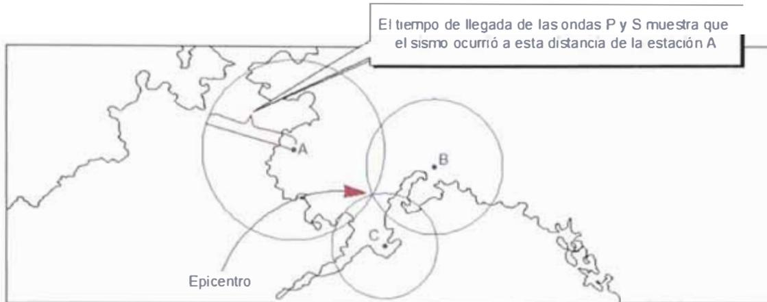
Figura 1.15: Localización preliminar del epicentro de un sismo en base a las medidas de la diferencia de los tiempos de llegada de las ondas P y S en los sismógrafos A, B y C (Kramer, 1996). La localización epicentral más probable se encuentra en la intersección de los tres círculos.
