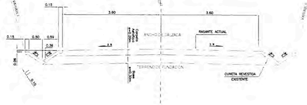
SECCION TIPICA EXISTENTE EN TANGENTE (CORTE CERRADO)
