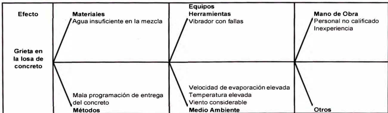
Luego del diagrama de causa y efecto en el que se analizaron las causas por las cuales se generan grietas en la losa de concreto, se determinó por la encuesta que la causa principal está en las condiciones del medio ambiente de la zona de trabajo, por lo tanto es importante tomar las medidas necesarias para evitar que las condiciones climáticas se conviertan en causas de fallas en este proceso.
