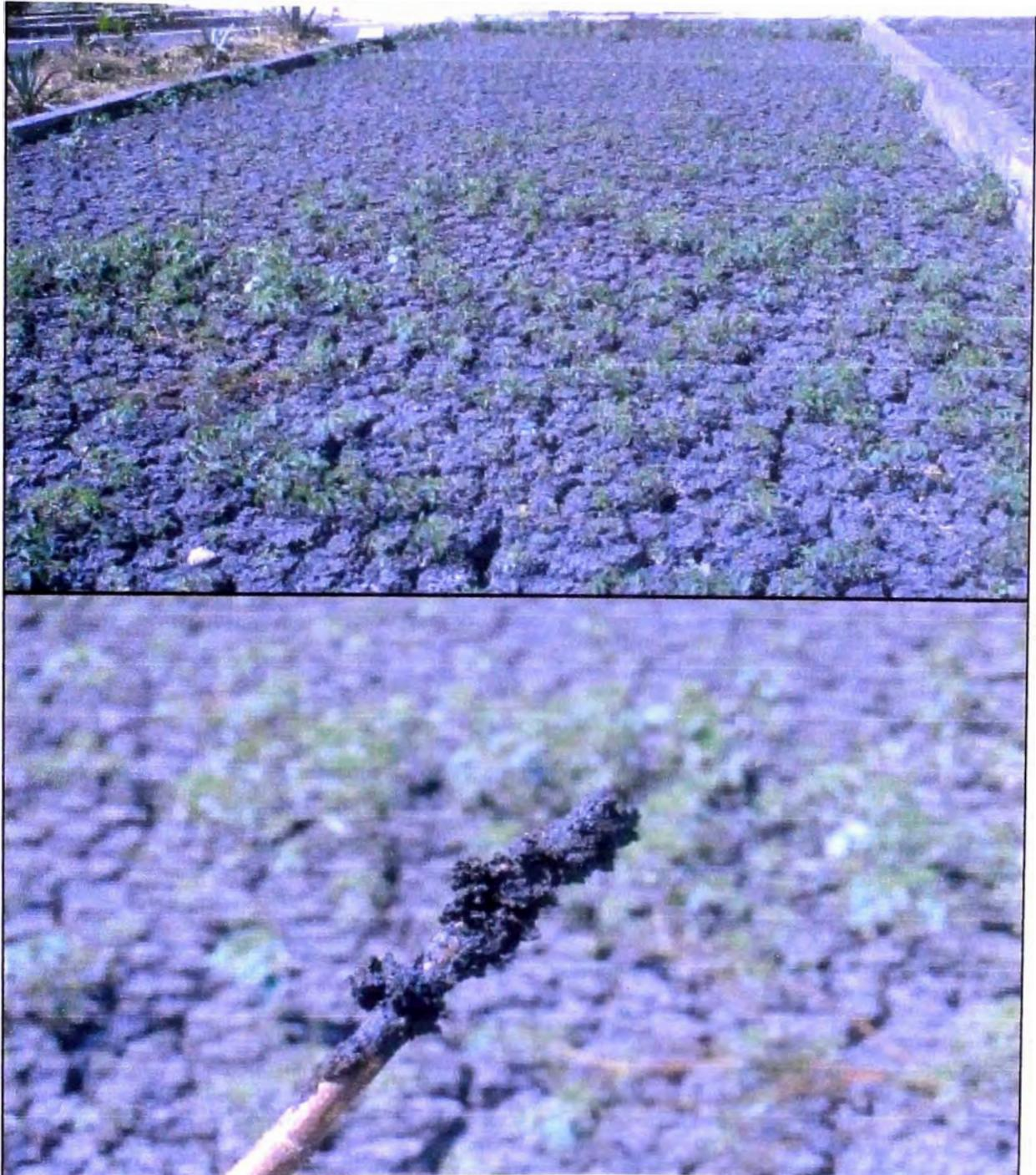
Foto 4.1. Cuando los lodos empiezan a secar la capa superficial forma una capa dura que previene el secado de las capas inferiores como se ve en las fotos de un lecho de secado. Mientras la capa superficial está seca (foto arriba), las capas inferiores mantienen su humedad como se ve después de meter un palo por adentro (foto abajo)
