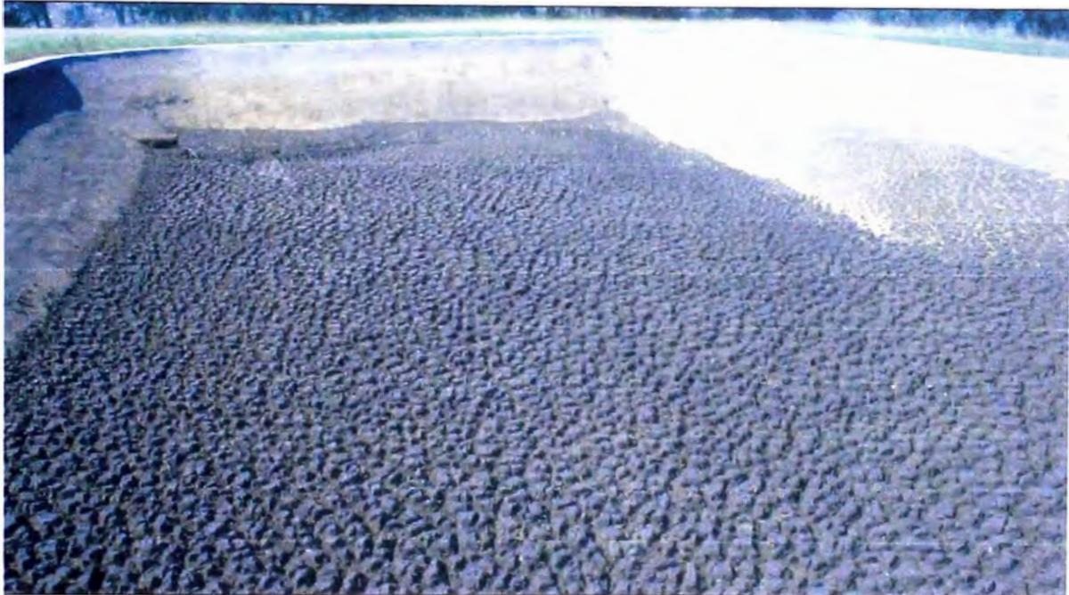
**Foto 4.3.** Un buen ejemplo de los lodos secos después de ser esparcidos y volteados periódicamente para facilitar el secado. Nótese la rampa para el acceso de equipo pesado
