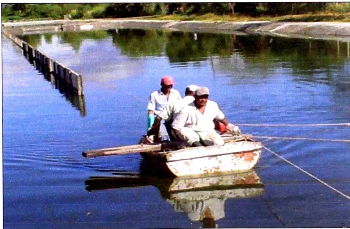
**Figura 1.5.** Operadores movilizándose en una laguna para medir la altura de los lodos
