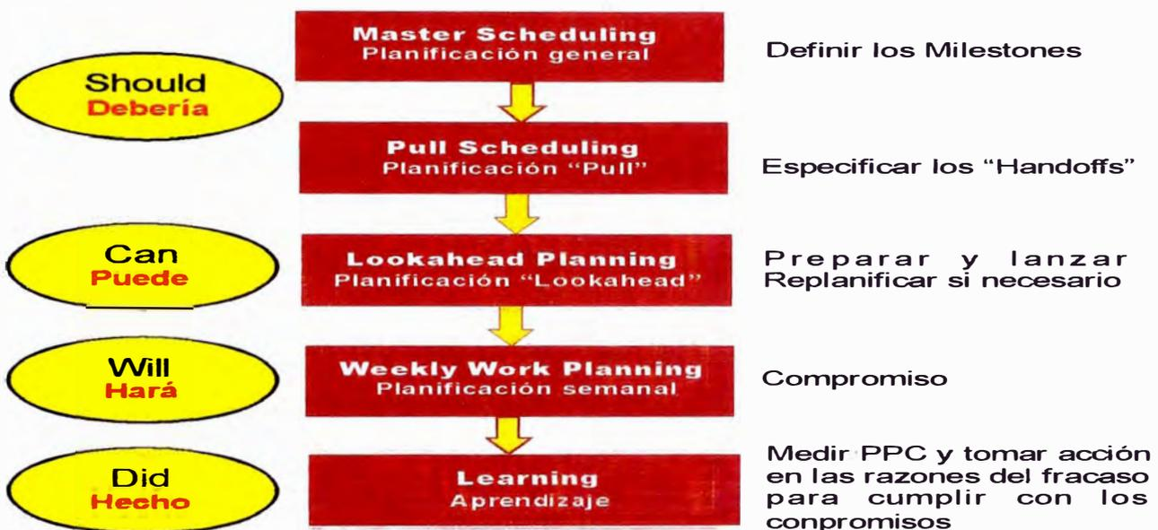
Fig.17: Diagrama del sistema de control de la producción del Ultimo Planificador
