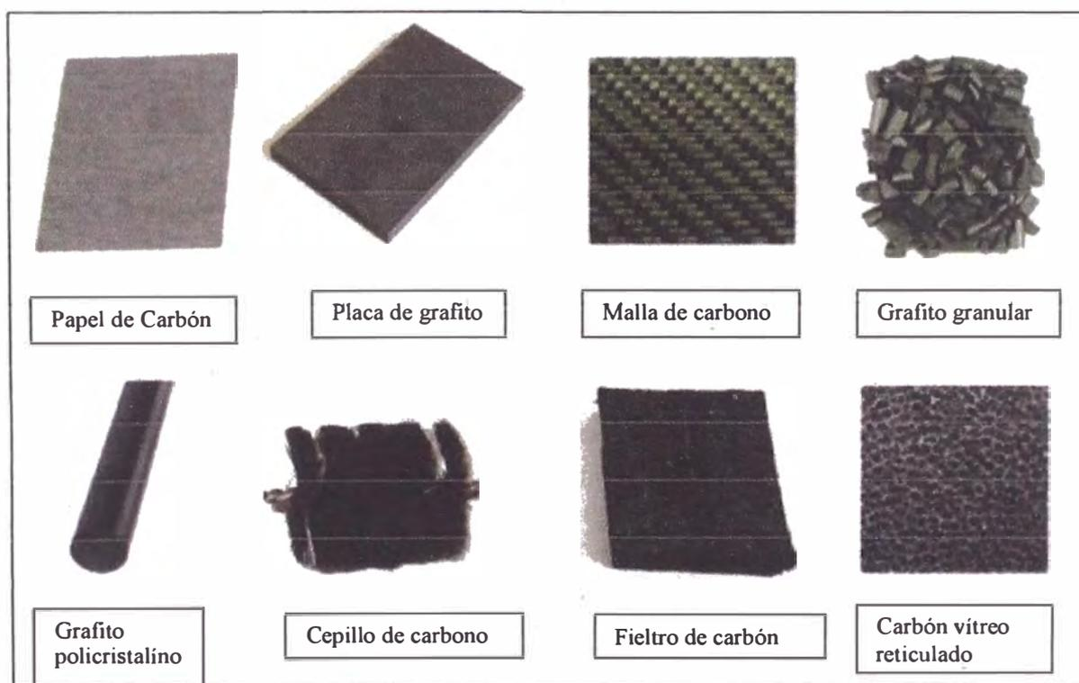
**Figura 2.** Materiales de carbono tradicionales utilizados como ánodos en celdas de combustible microbianas (MFC). *Imagen adaptada de Scott (2015).*
