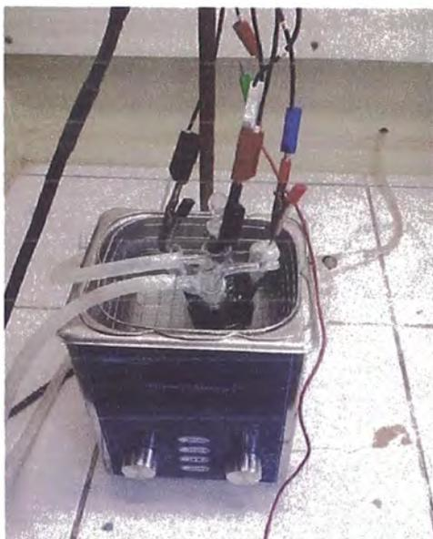
**Figura 31.** Preparación de compuesto a través de un baño ultrasónico del electrodo con polianilina en una dispersión de nanotubos de carbón en medio HCl .
