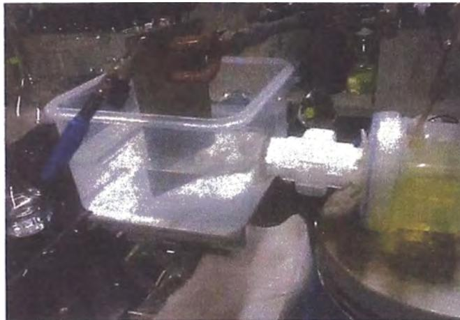
**Figura 12.** Electrólisis de oro en una celda electroquímica.
