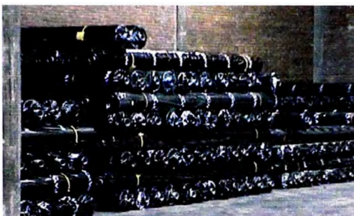
Figura 5.3 Almacenamiento de rollos de Geotextil No Tejido en almacén.
