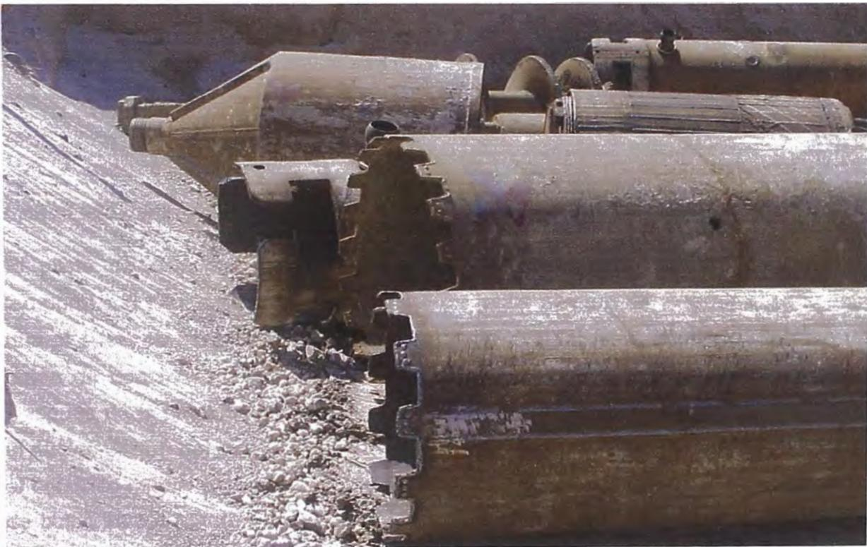
Figura N°11\_ Molde recuperable para pilotes vaceados in situ
