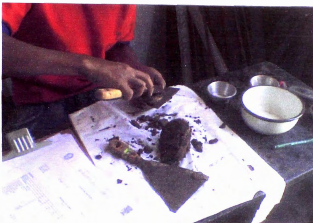
Foto Nº 27: Moldeo de muestra de subrasante para ensayo de densidad de campo.
