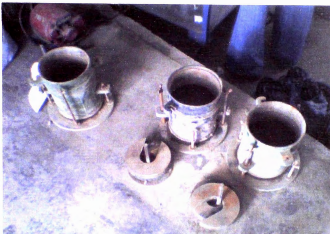
Foto N° 19: Moldes para toma de muestras in situ en poza experimental para ensayo de CBR.
