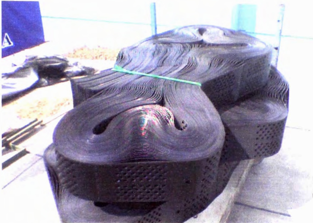
Foto N° 31: La sección de Geoweb es muy compacta que permite el ahorro de espacio y peso.
