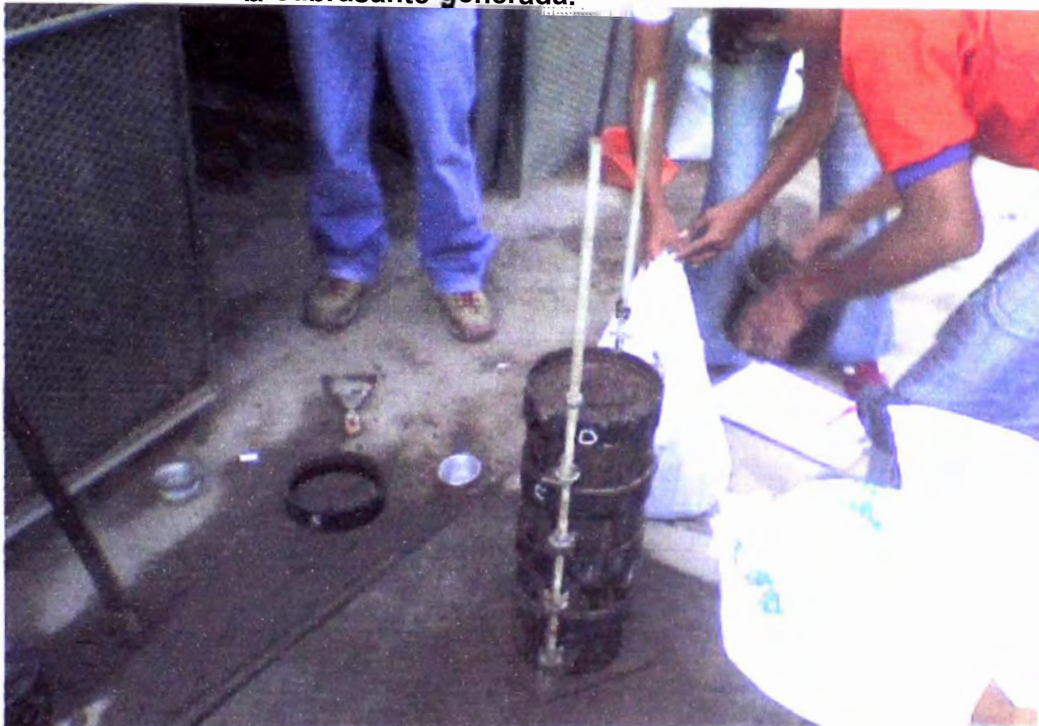
Foto N° 30: Ensayo de CBR para la determinación de la correlación con el ensayo de DPL.
