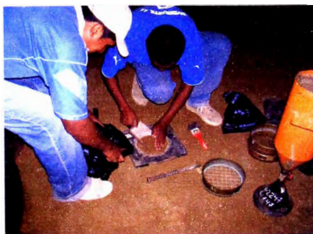
Figura 20. Control de compactación
