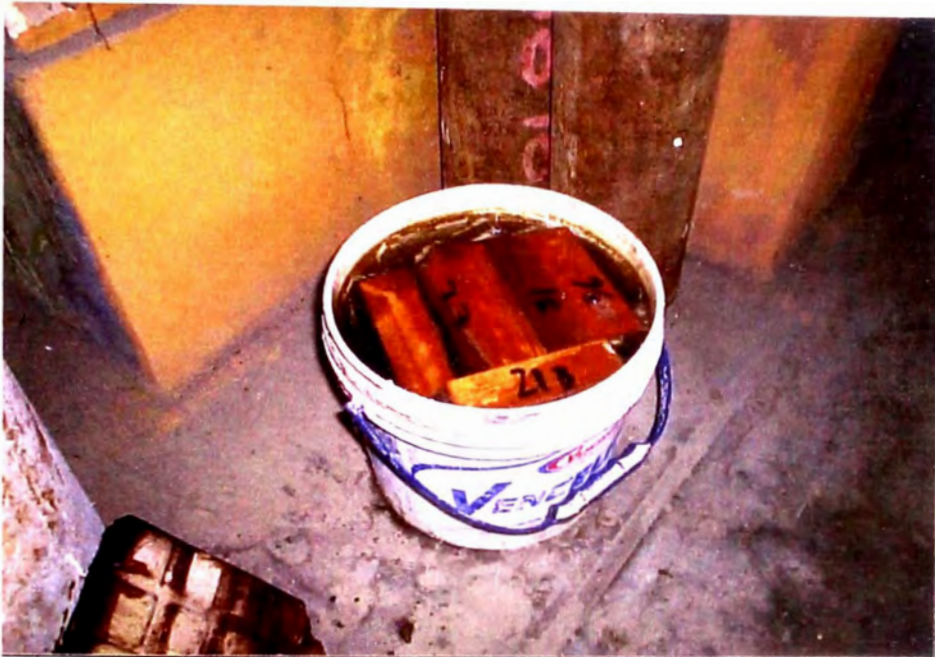
Saturando las muestras para la obtención de la Densidad Básica.
