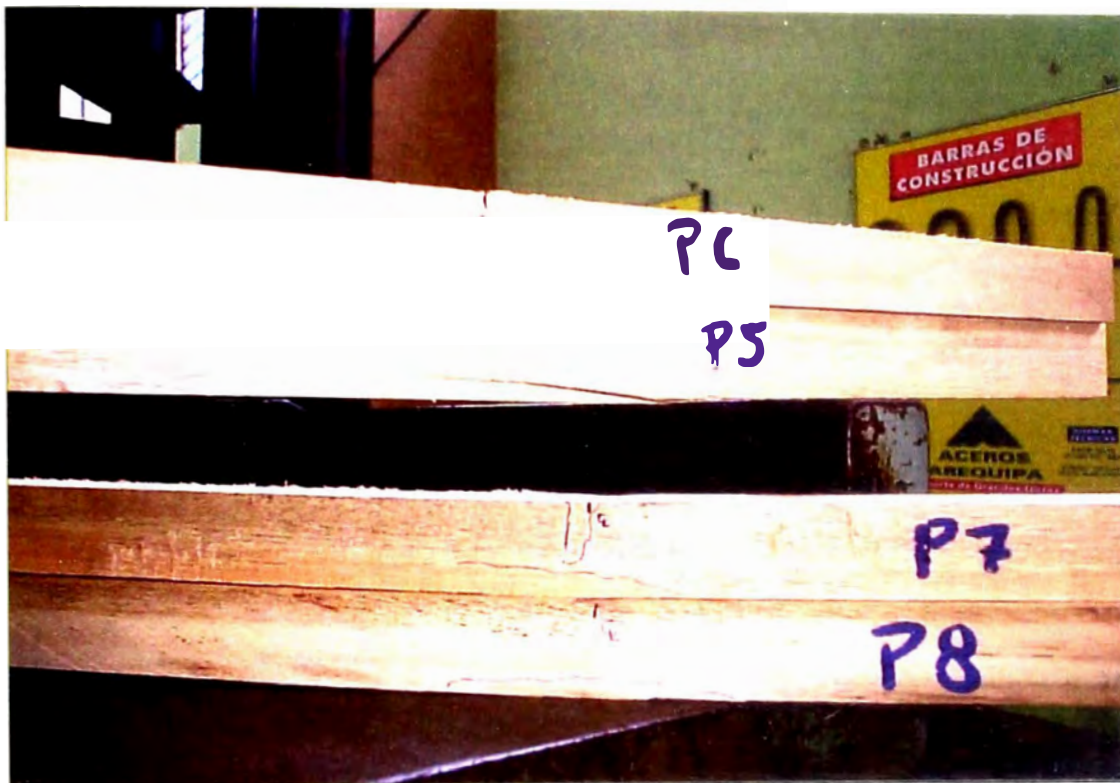
Fallas observadas en probetas de 2.5x2.5 de sección transversal y 35 cm de luz.
