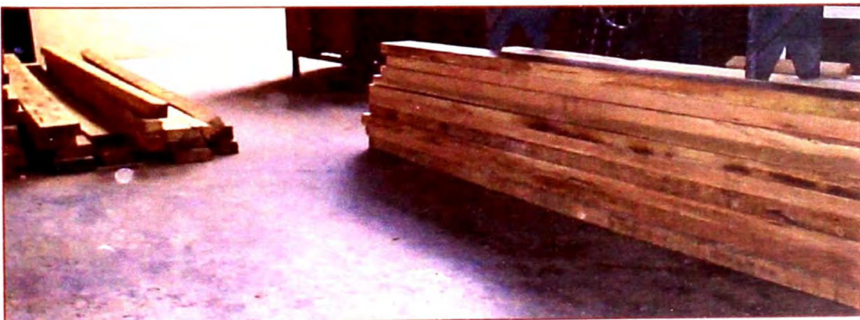
Fig. 3.5: Selección de Vigas para el cepillado (Izquierda superior), y Vigas cepilladas de 4x14x300cm (Derecha). UNI, Lima.
