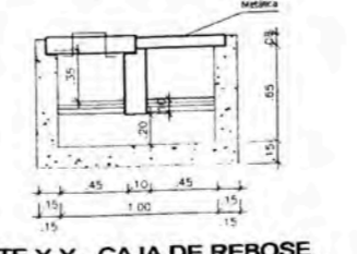
CORTE Y-Y - CAJA DE REBOSE ESC. 1/25
