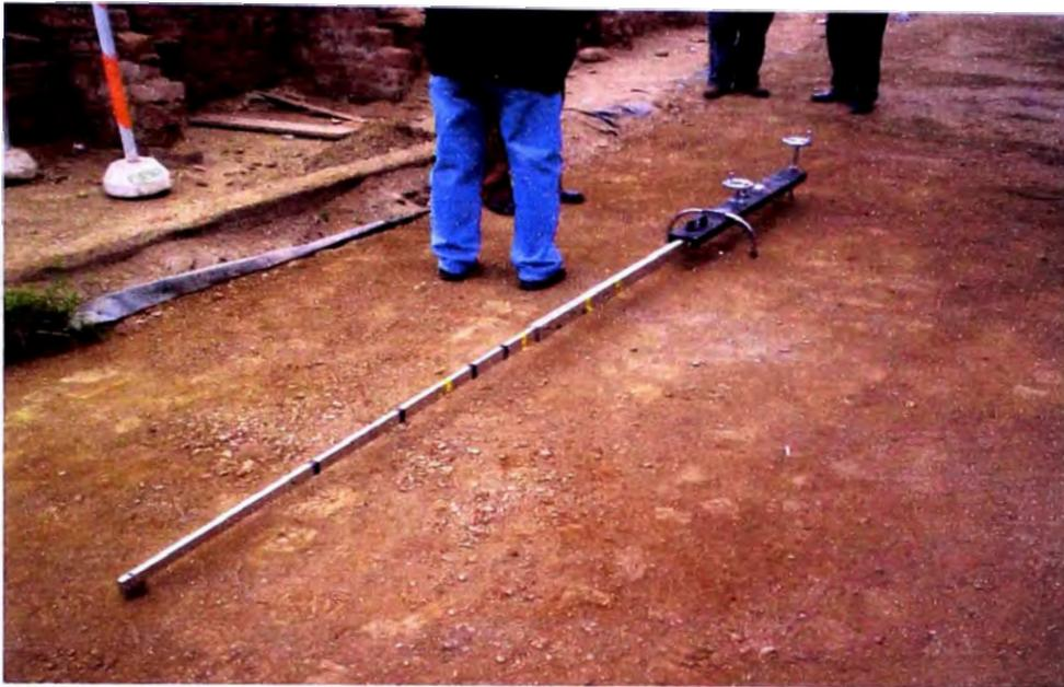
Foto 1: Equipo Viga Benkelman
