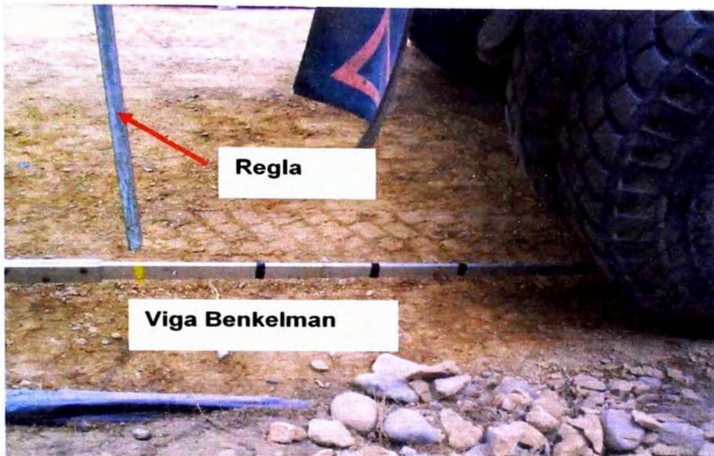
**Foto 7:** Posicionamiento de la viga Benkelman alineada con la regla vertical instalada en el camión
