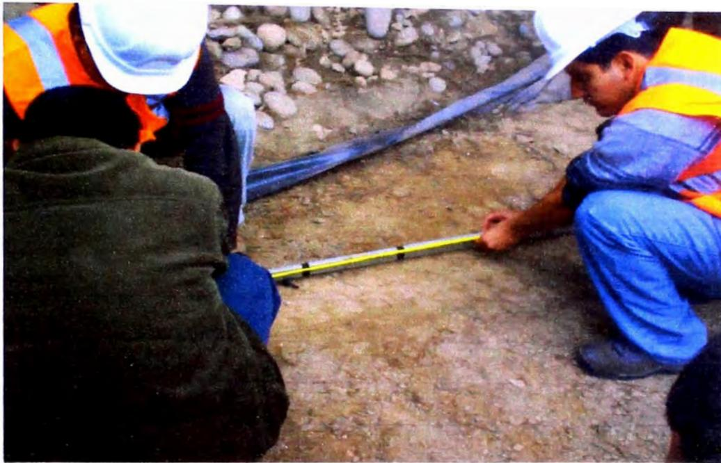
**Foto 5:** Medición en la viga Benkelman de las distancias en que se tomaran los datos en el dial
