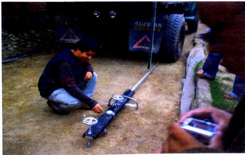
**Foto 6:** Chequeo del buen funcionamiento de la Viga Benkelman
