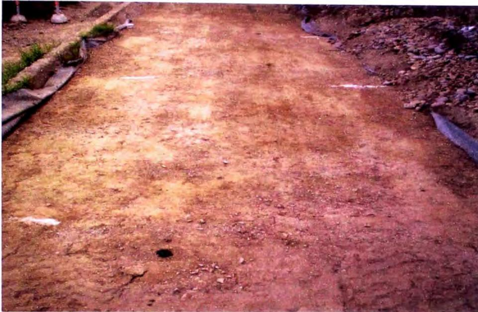
**Foto 4.5:** En esta foto se observa como quedo el tramo diseñado con Geomalla después del paso del camión cargado, el ahuellamiento que se aprecia en la parte inferior de la foto tiene una profundidad aproximadamente de 0.05 m.
