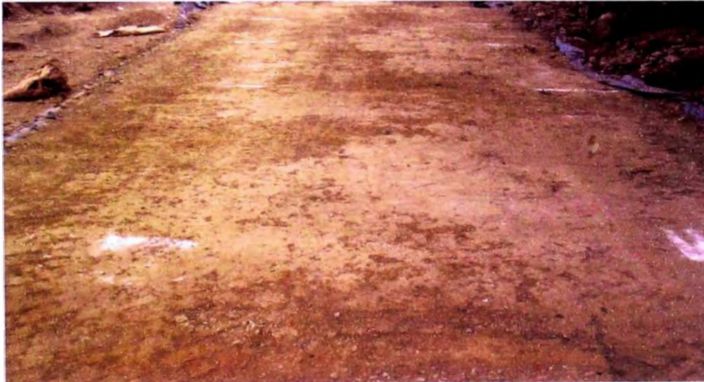
**Foto 4.4:** En esta foto se observa como quedo el tramo diseñado con Geotextil después del paso del camión cargado, como se puede apreciar en la parte inferior de la foto en esta zona existen huellas leves que tienen alrededor de 5 mm. de profundidad.
