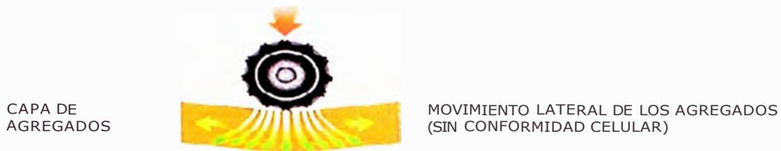
**CUANDO LAS CARGAS TRANSMITIDAS A LA EXPLANADA DEBIDAS AL TRAFICO (RUEDAS) SON SUPERIORES A LA CAPACIDAD PORTANTE DEL TERRENO SE PRODUCEN LAS HUELLAS**
