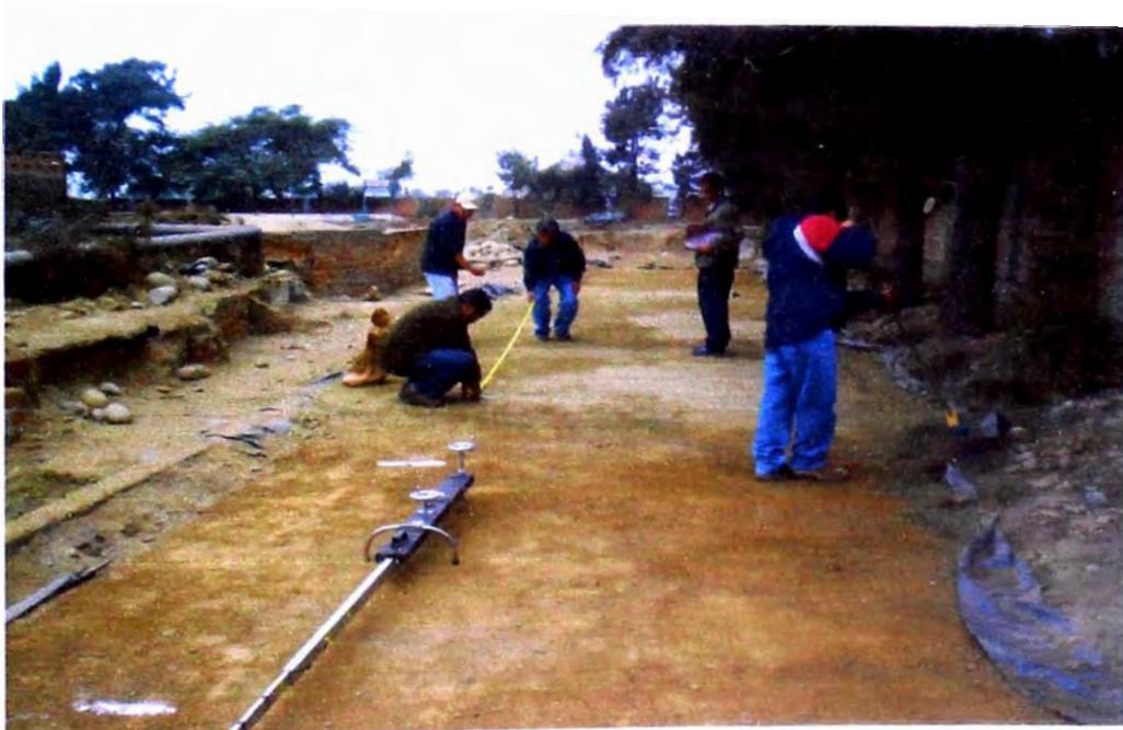
**Foto 4:** Ubicación de puntos de ensayo en los tramos de carretera con geotextil y geomalla para la medición de la deflexión
