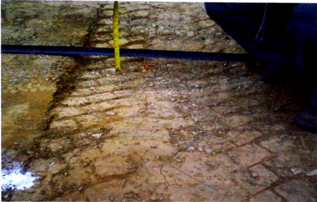
**Foto 11:** Medición de la huella dejada por el paso del camión en el tramo de carretera con geomalla (5 cm aprox.)
