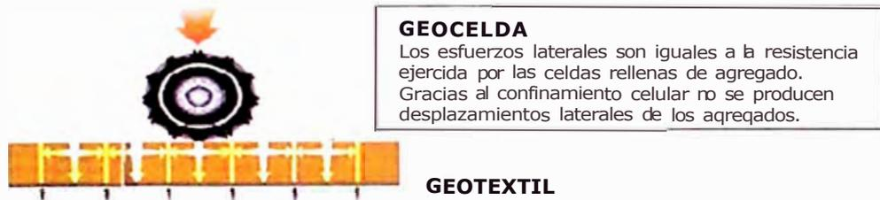
**LAS CARGAS TRANSMITIDAS A LA EXPLANADA DEBIDAS AL TRAFICO (RUEDAS) SON IGUALES A LA CAPACIDAD PORTANTE DEL TERRENO (RESISTENCIA DEL TERRENO) POR LO QUE NO SE PRODUCEN LAS HUELLAS**
