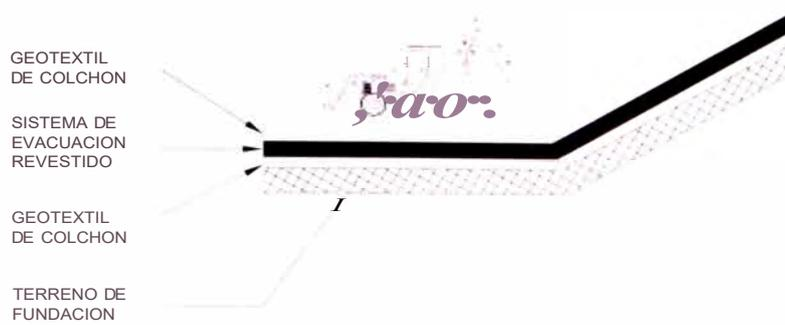
**Fig. 1.8:** Geotextil de colchón, que protege al sistema de evacuación del daño debido a las rocas, escombros u otros materiales
