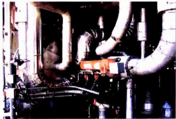
Tuberías que alimentan a la vasija de presión donde se produce la gasificación del carbono.
