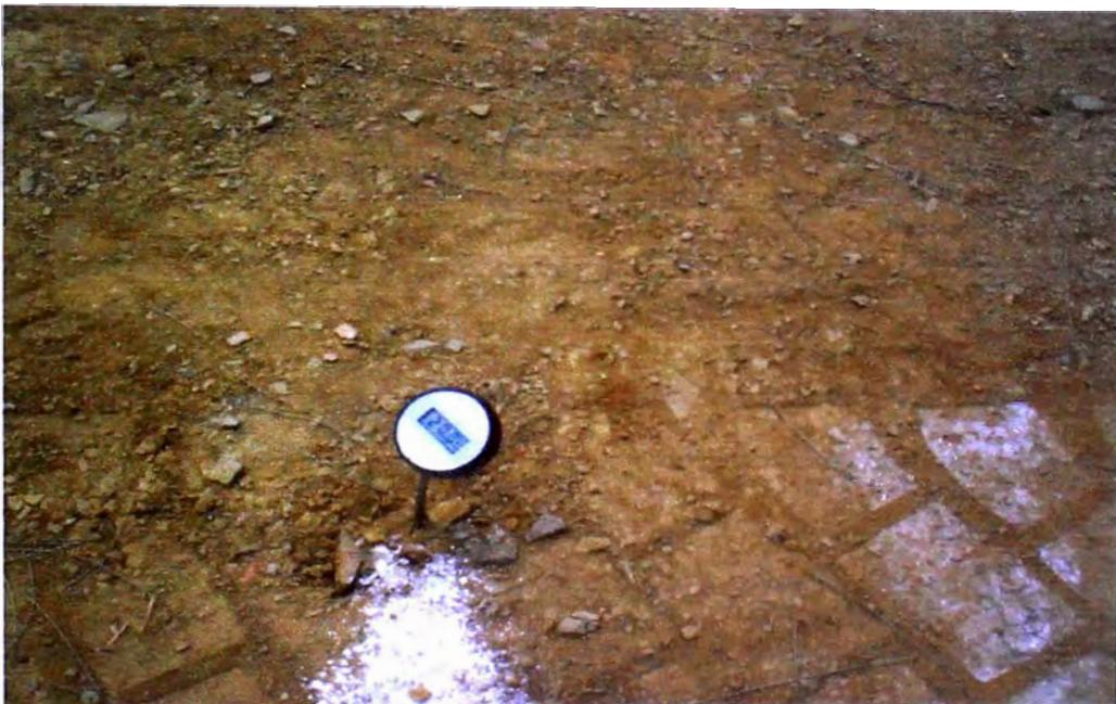
**Foto 10:** Lectura de la temperatura del pavimento en el punto de ensayo del tromo de carretera con geomalla
