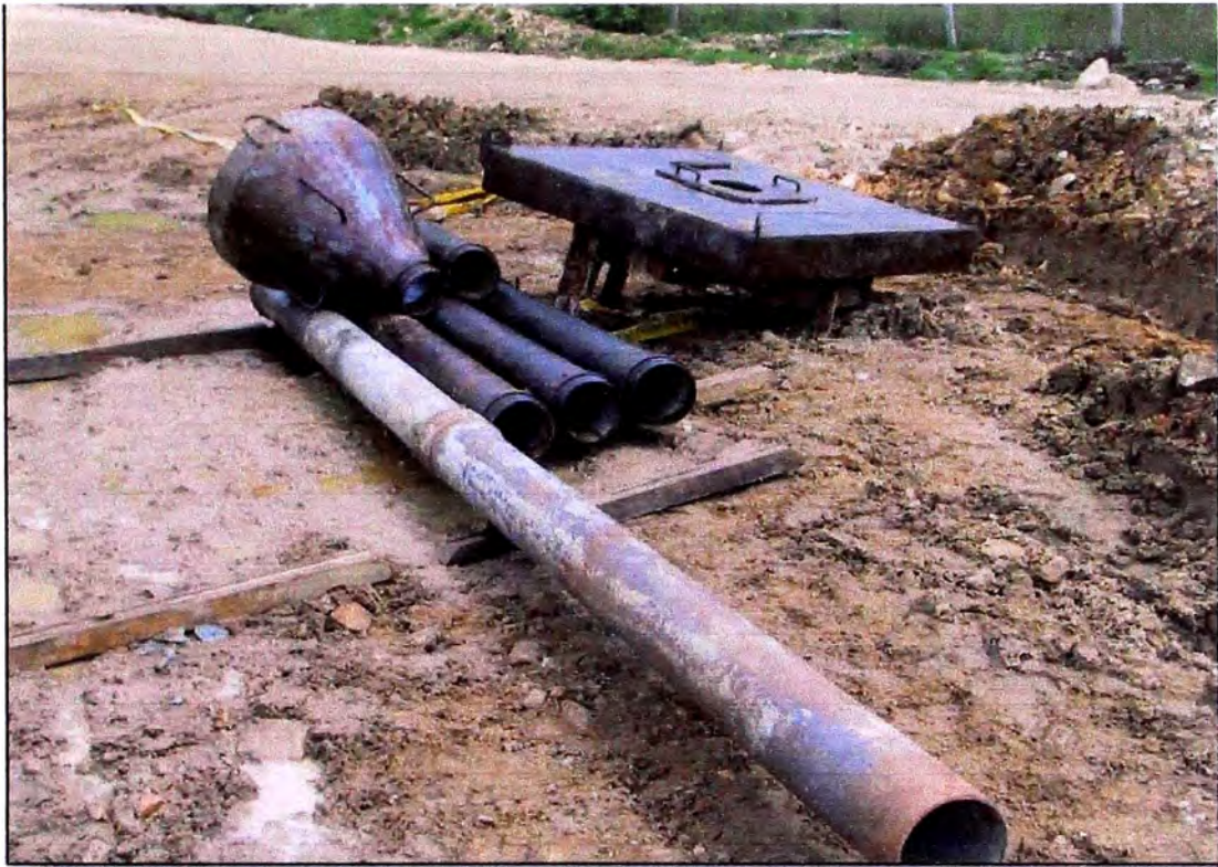
7.- EQUIPO DE VACIADO - SISTEMA TREMIE
