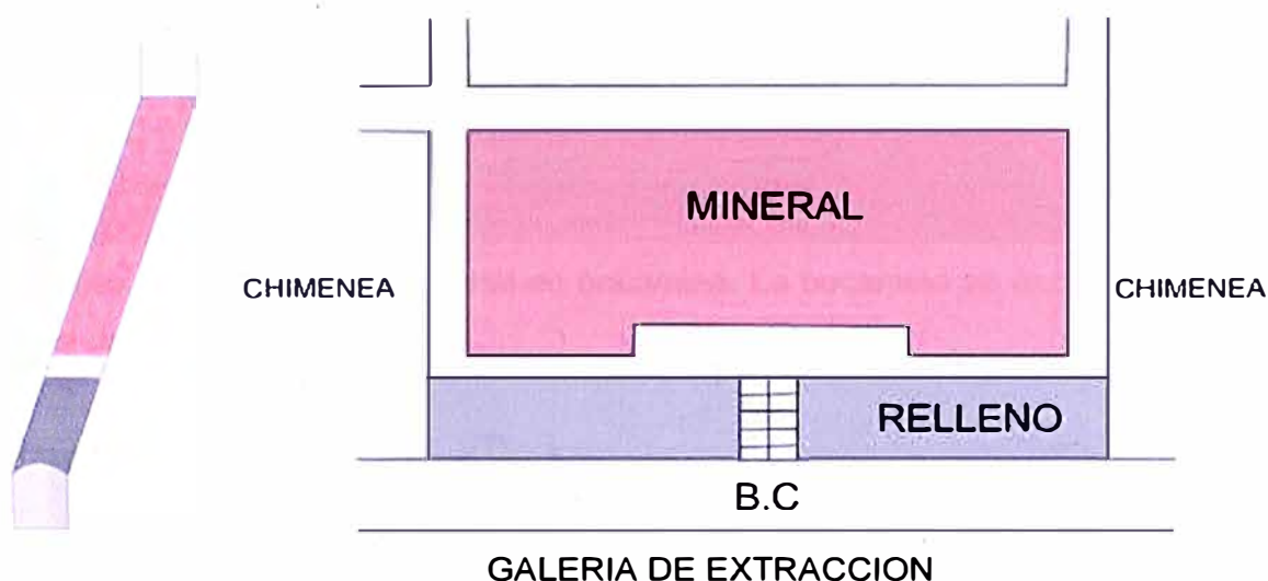
GRAFICO 1.1: Método de Explotación Corte y Relleno Ascendente
