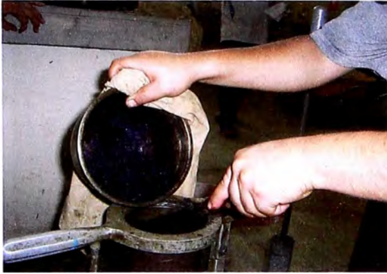
(g) Colocación de la muestra en el molde Compactador
