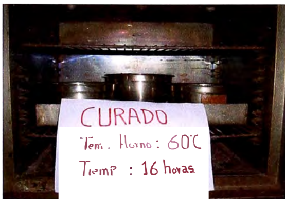
(e) Proceso de curado en horno a 60°C durante 16 horas.
