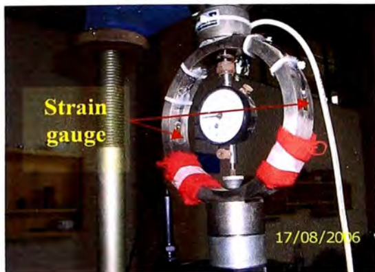
Strain gauge adheridos en el anillo de carga.
