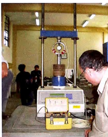
Proceso de calibración de los sensores instalados
