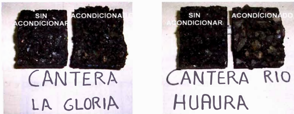
Figura 3.21 Briquetas sometidos a rotura por tracción indirecta
