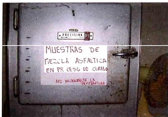
(f) Calentado en horno de la mezcla a temperatura de compactación por espacio de 2 horas
