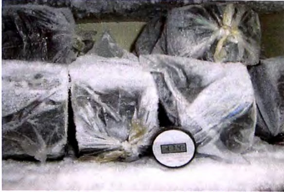
(c) Ciclo de congelamiento -18^{\circ}\text{C} \pm 6^{\circ}\text{C} durante 16 horas
