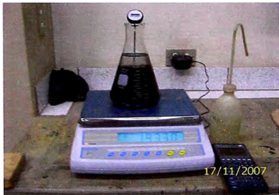
Peso y temperatura de la mezcla luego de quitar los vacíos
