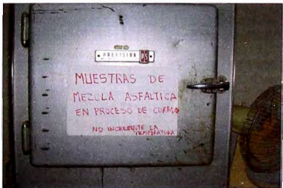
(f) Calentado en horno de la mezcla a temperatura de compactación por espacio de 2 horas
