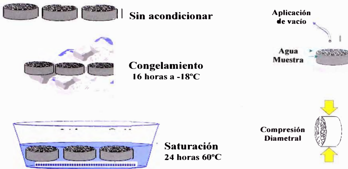
Figura 2.17.- Esquema del ensayo AASHTO T283 Lottman Modificado
