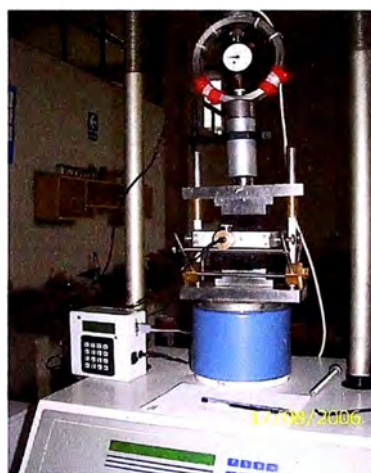
Sensores de deformación instalados y calibrados
