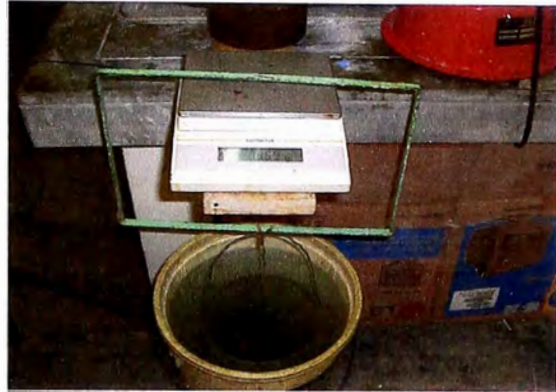
(d) Control del grado de saturación.
