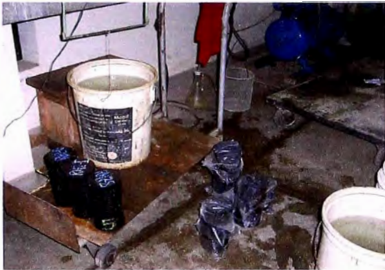
(e) embolsado de muestras que van a ser congeladas o sometidos a inmersión.
