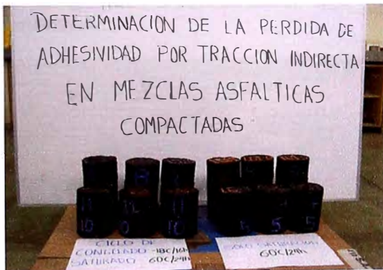
(a) Separación de muestras por grupos para su acondicionamiento.
