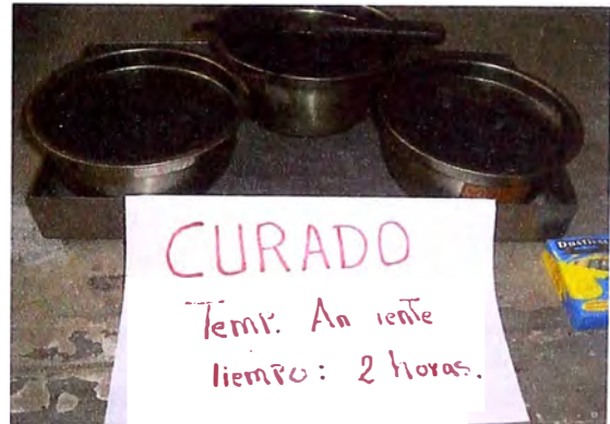
(d) Proceso de curado a temperatura de ambiente durante 2 horas.
