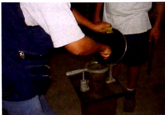
Llenando el molde con la mezcla
