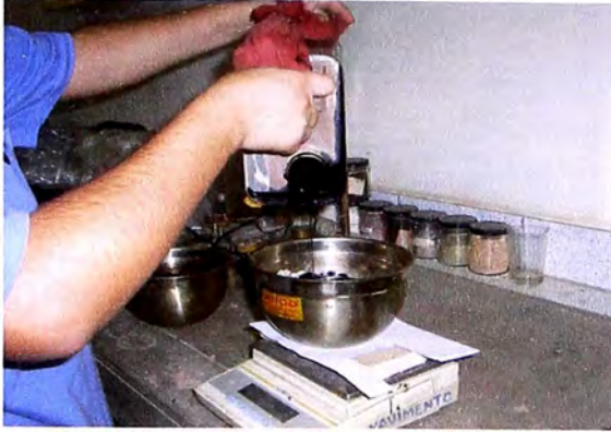
(a) Adición del asfalto previamente calentada en horno, a los agregados.
