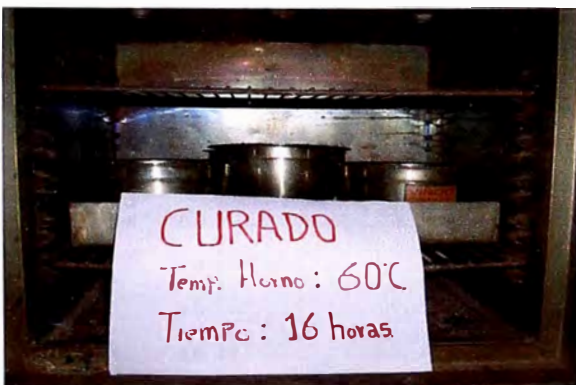
(e) Proceso de curado en horno a 60^{\circ}\text{C} durante 16 horas.
