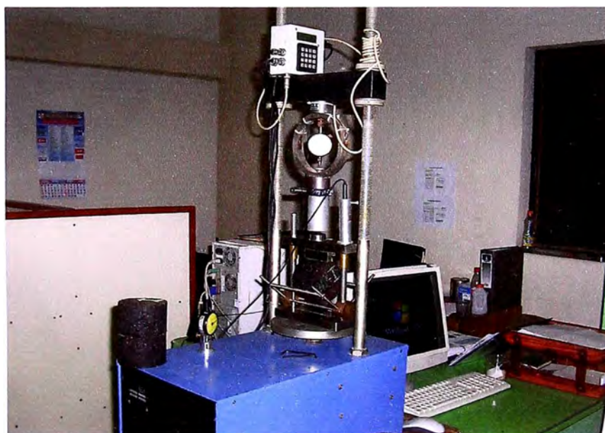
Equipo Marshall Automatizado
