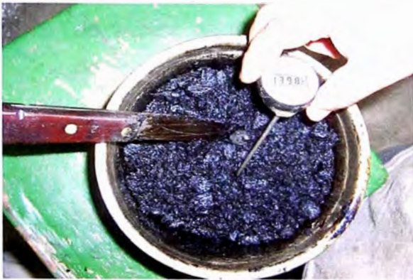
(c) Temperatura de mezcla determinado de acuerdo a la carta de viscosidad.
