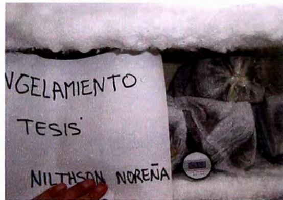
(f) proceso de congelamiento a -18^{\circ}\text{C} durante 16 horas
