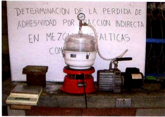
(c) saturación forzada al vacío en el equipo Rice.
