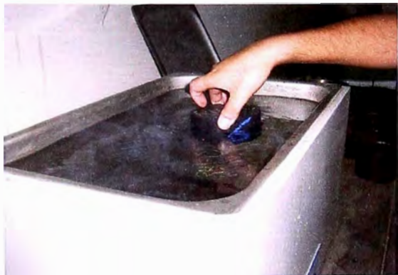
(g) proceso de inmersión a 60^{\circ}\text{C} durante 24 horas
