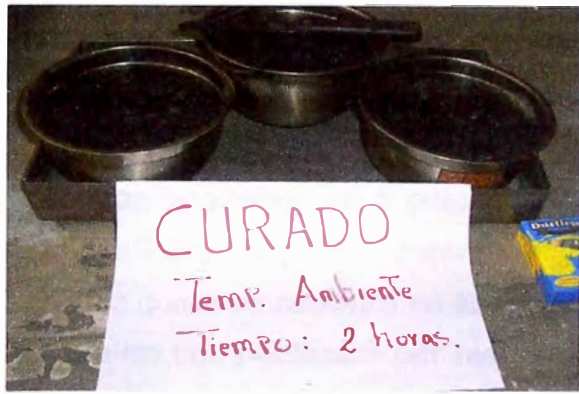
(d) Proceso de curado a temperatura de ambiente durante 2 horas.
