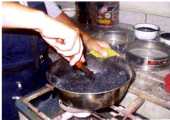
Mezclando para compactar las briquetas
