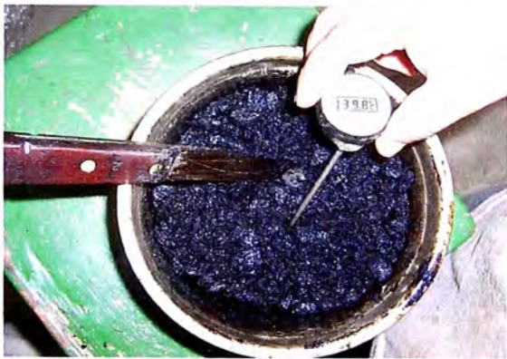
(c) Temperatura de mezcla determinado de acuerdo a la carta de viscosidad.
