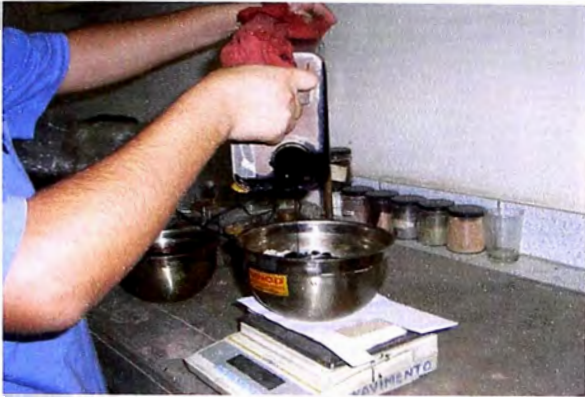
(a) Adición del asfalto previamente calentada en horno, a los agregados.
