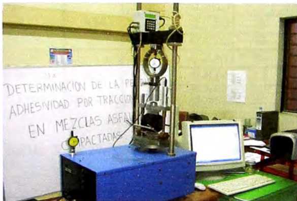
(a) Ensayo de tracción indirecta en la prensa Marshall automatizada
