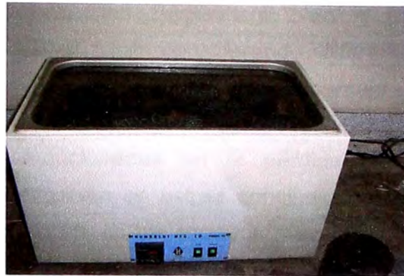
(d) Inmersión a 60^{\circ}\text{C} por 24 horas
