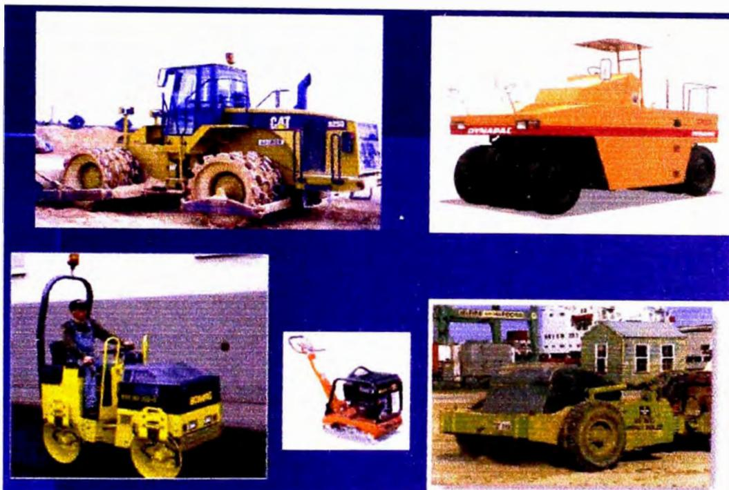
Foto 2-14 Equipos de Compactación. Se usará Motoniveladora en los lugares que se necesite mayor uniformidad de los materiales compactados.
