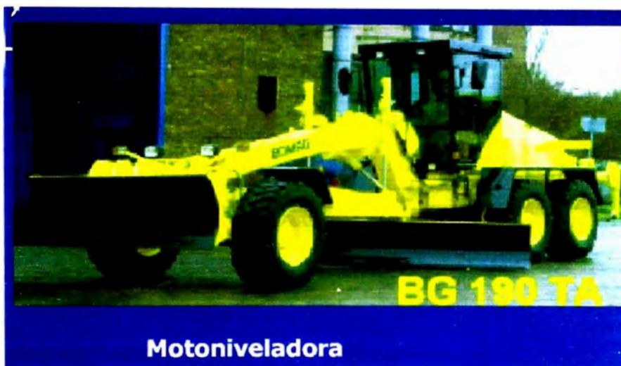
foto 2-16: Se usará Motoniveladora para evitar toda irregularidad en la compactación
