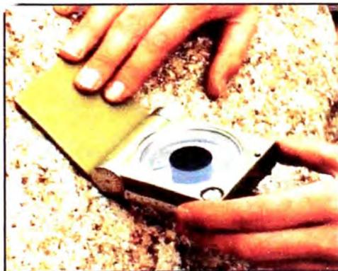
**Fotografía N° 2.-** Posición de la brújula sobre la superficie de roca para establecer la dirección de buzamiento (Evert Hoek).
