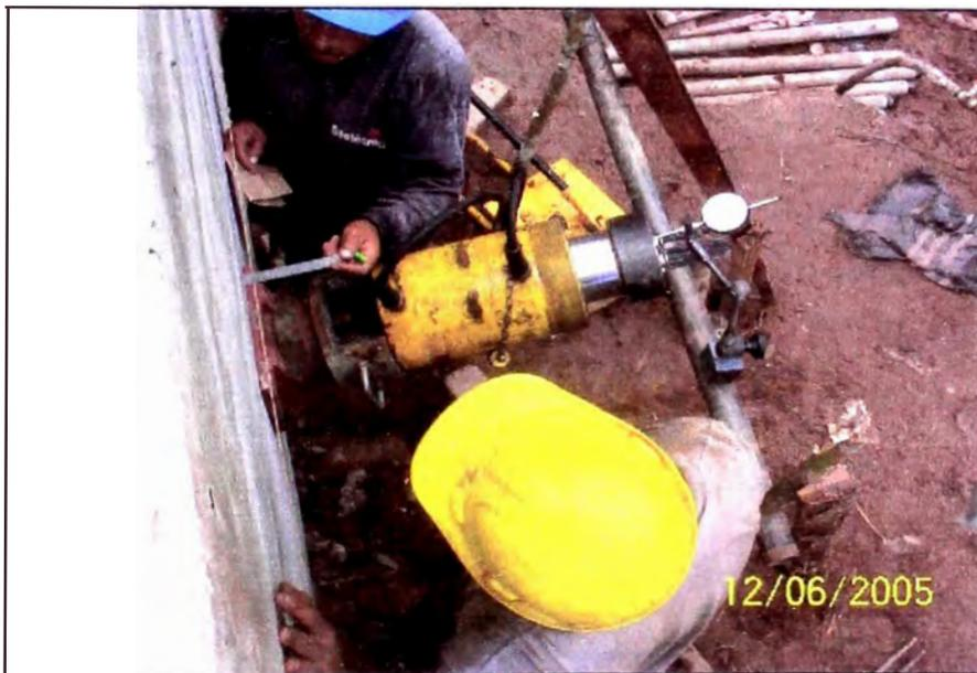
Fotografía N° 37.- Medición de desplazamiento relativo del tramo de muro con pie de rey, con respecto a la tensión de los cables de la vista.
