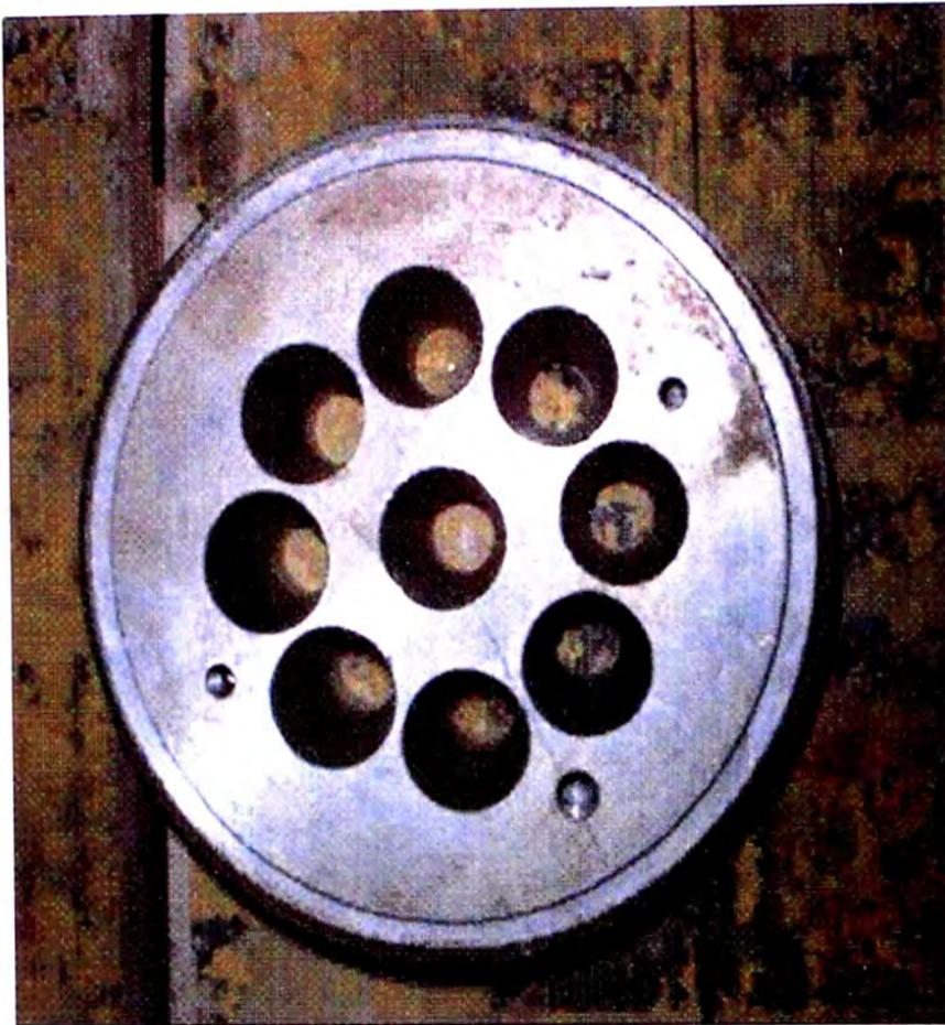
**Fotografía N° 21.-** Cabezal retensable de 9 agujerJs troncocónicos para cables de Acero de 5/8".
