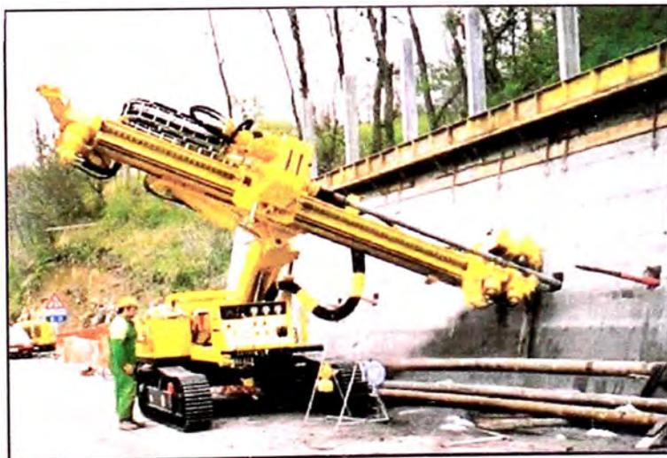
**Fotografía N° 13.-** Equipo de perforación Hidráulico - Mustang.
