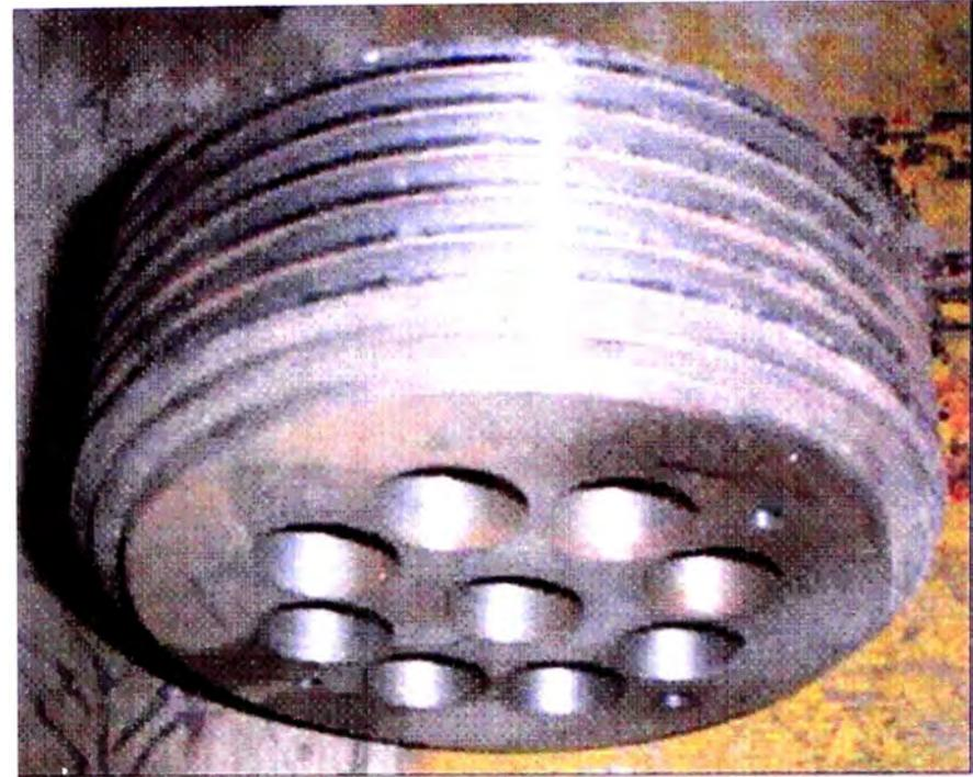
**Fotografía N° 22.-** Cabezal retensable, se observa el detalle roscado, para poder ejecutar el retensado.
