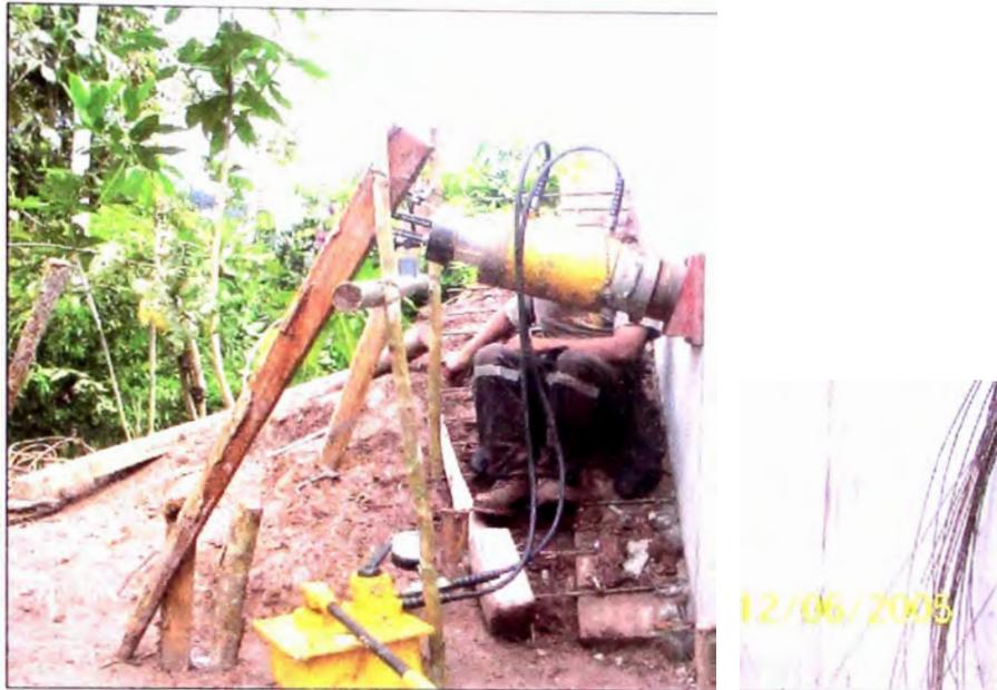
Fotografía N° 36.- Equipo de Tensión dispuesto para el Ensayo.
