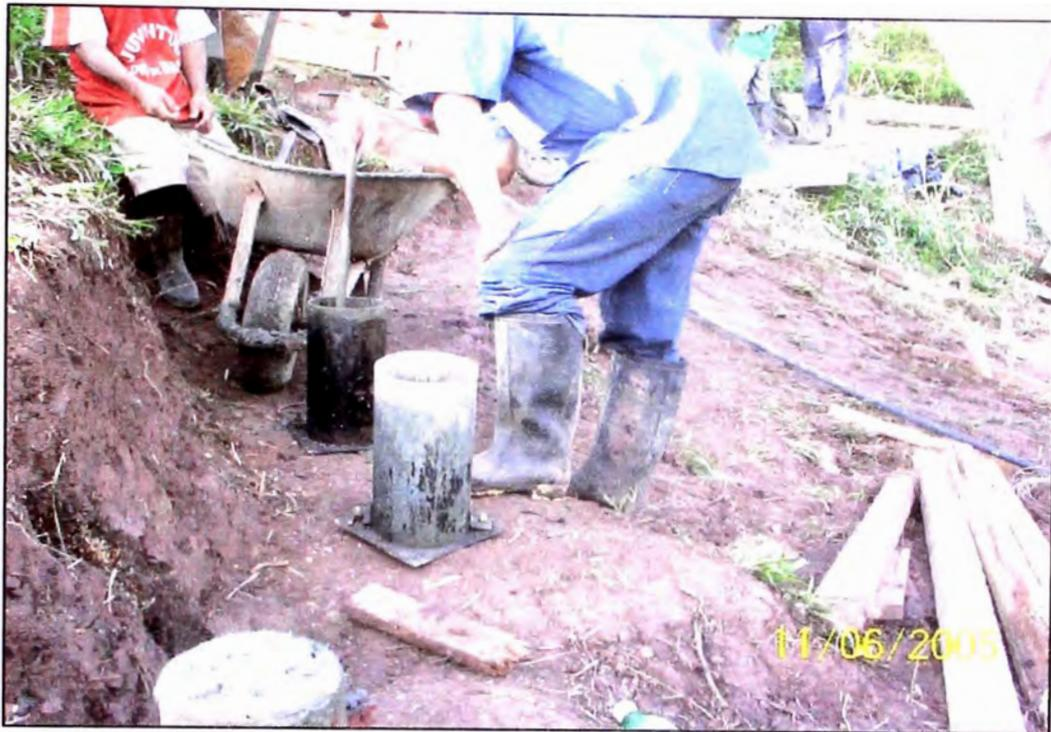
**Fotografía N° 44.-** Preparación de probetas para ensayo de resistencia de mezcla de concreto.
